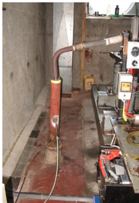
Слика 11. Лабораторијски издувни систем са сондама [10]
