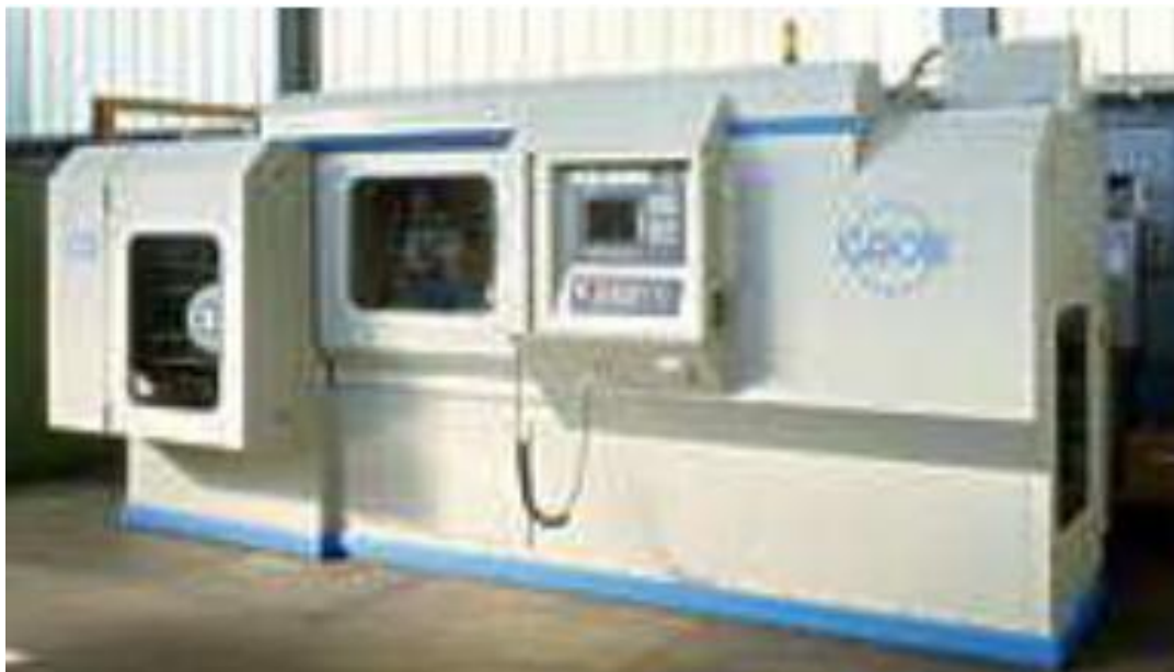
Слика 56. Машина за израду зупчаника ваљањем на хладно [20]
