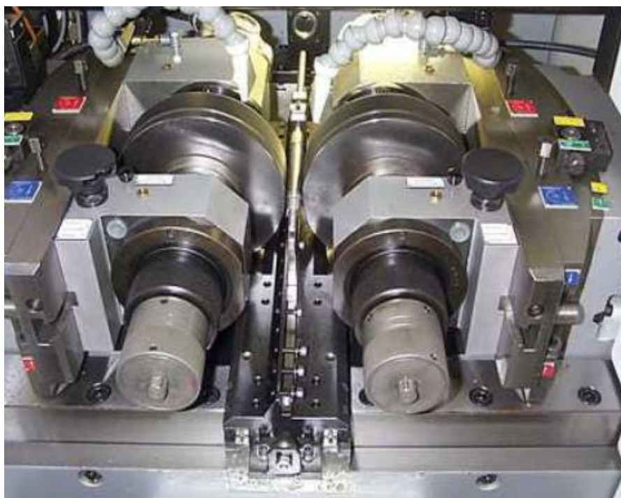
Слика 53. Савремена машина за ваљање зуба зупчаника у хладном стању [32]
