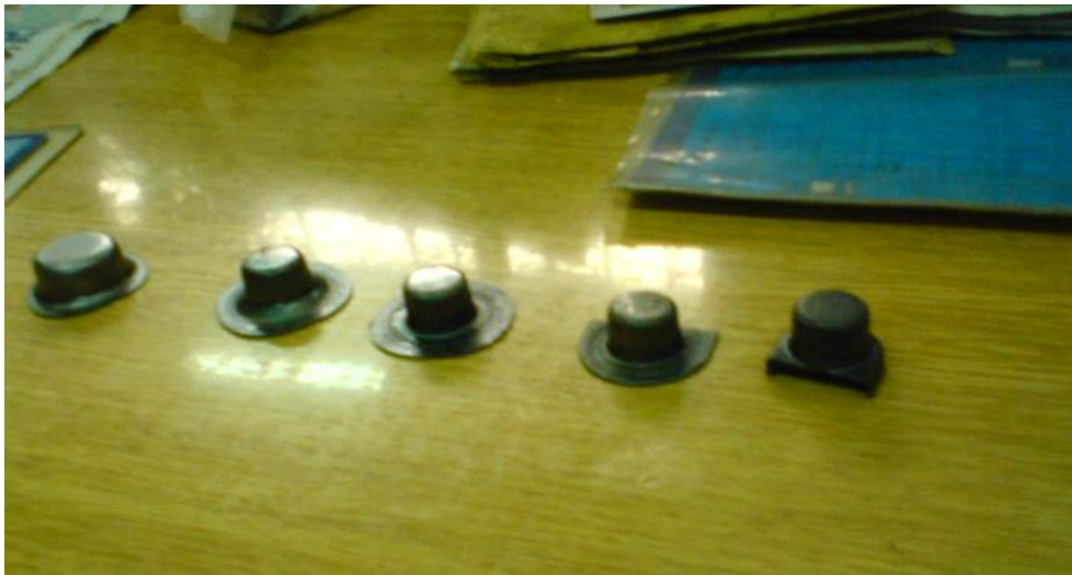
Слика 5. Трансформација радних комада током операција
