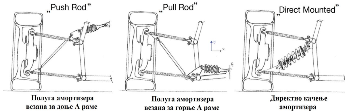
Слика 3.15 Везе између А рамена и амортизера
