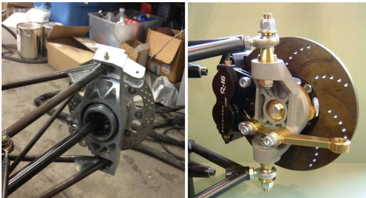
Слика 3.23. Основна два концепта носача главчине – алуминијумски носач добијен обрадом из комада и челични модуларни тип
