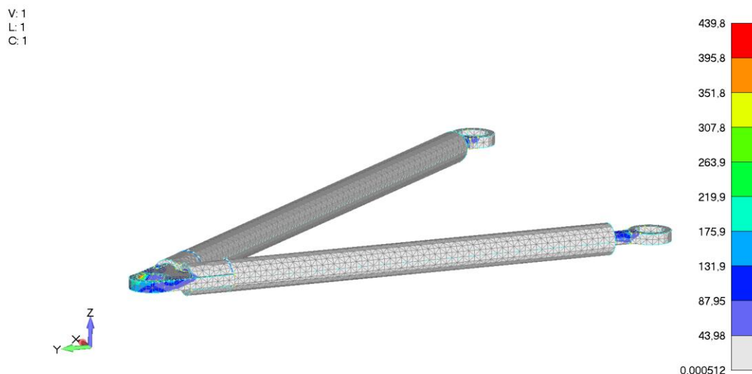
Слика 6.5 Интензитети и расподела еквивалентних напрезања према Von Misesu
