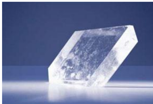
Слика12: Приказ пиезоелектричног кристала
