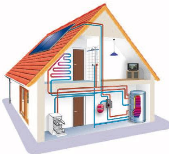
Слика 5. Добијање топле воде коришћењем соларног колектора 15
