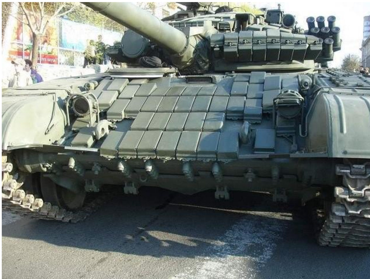
Слика 3.7: Активно-реактивни оклоп монтиран на тенк [12]
