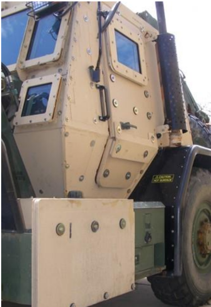
Слика 3.3: Заштитни оклоп од керамичких плоча [8]
