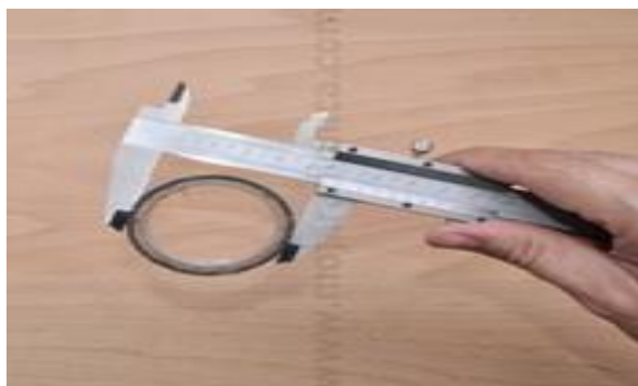
Слика 10. Нормалан начин држања мерила Слика 11. Мерење спољашњих димензија
