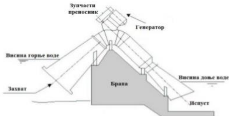
Слика 8. Нископритисна хидроелектрана са сифонским доводом
