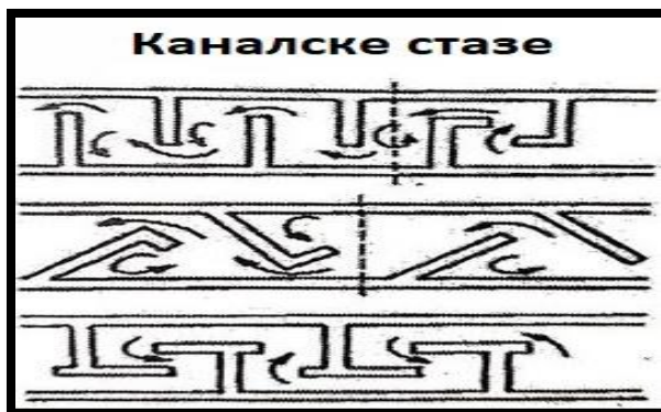
Слика 24. Приказ различитих типова каналских рибљих стаза [2]
