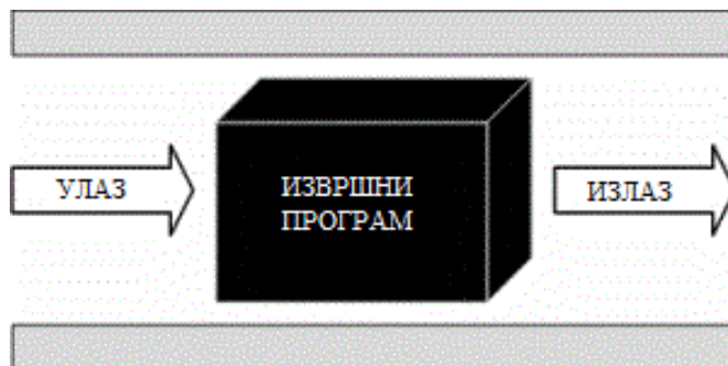
Слика 4. Принцип тестирања методом црне кутије
