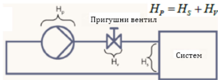
Слика 3.27. Систем са пригушним вентилом [9]
