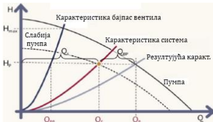
Слика 3.30. Подешавање карактеристика са бајпас системом [9]
