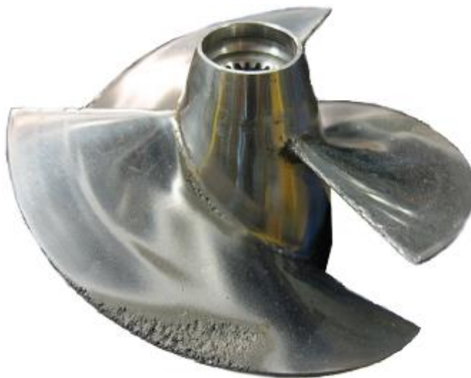
Слика 3.11. Последице ерозије на лопатици пумпе изазване кавитацијом [8]
