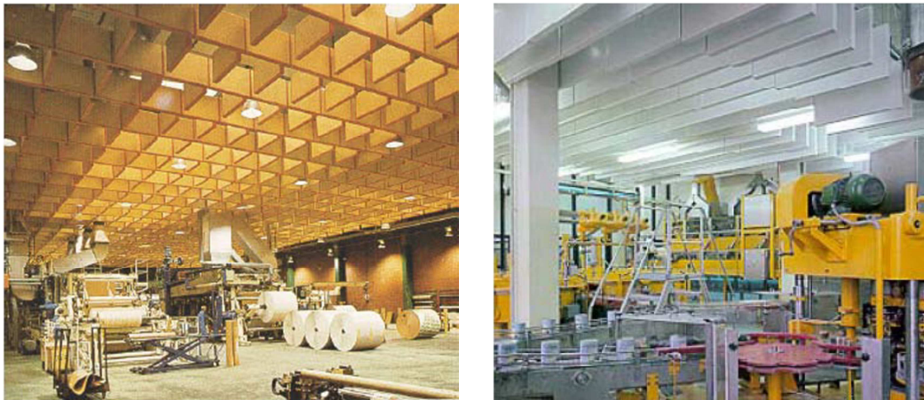
Слика 16. Примена апсорпционих материјала у смањењу буке
