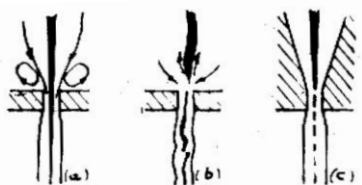
Слика 16 Утицај конструкције матрице на течење и разарање екструдата [3]
