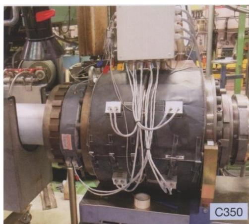
Слика 54 Глава за екстудирање каблова и проводника великог пресека фирме „CJ TEC“ [5]
