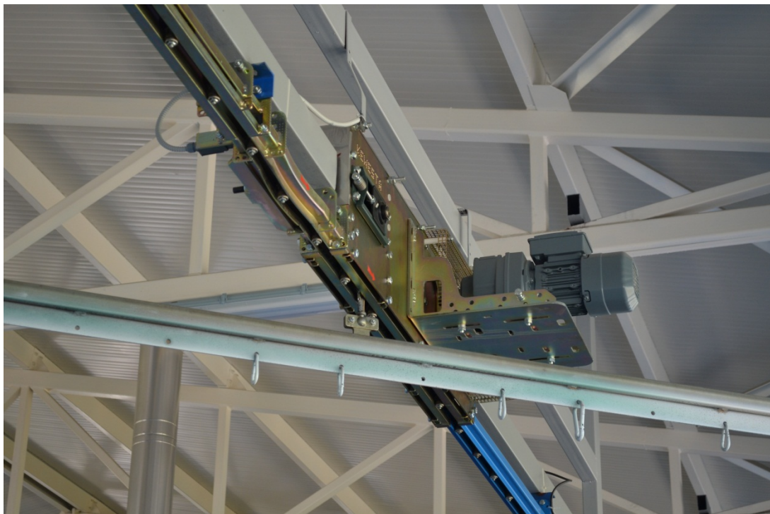
Слика 3.6 Погонска група транспортног ланца (конвејера)
