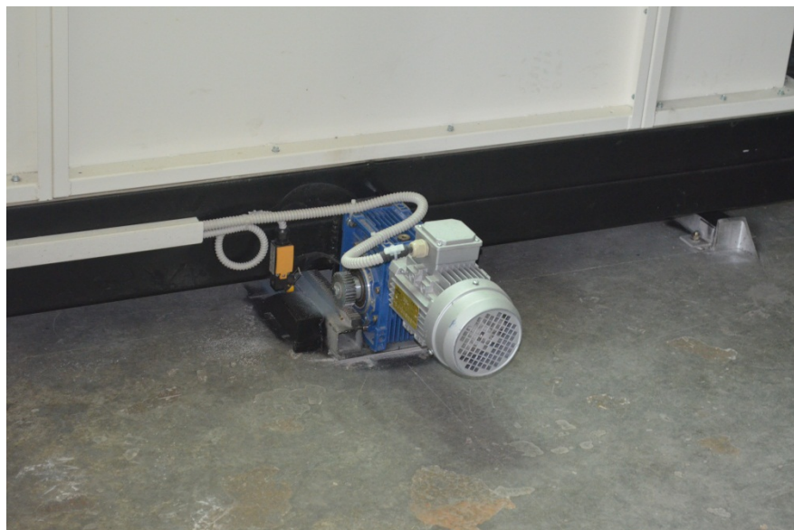
Слика 3.3 Комбиновани преносник (зупчаник-зупчаста летва која добија погон од електромотора преко пужног редуктора)
