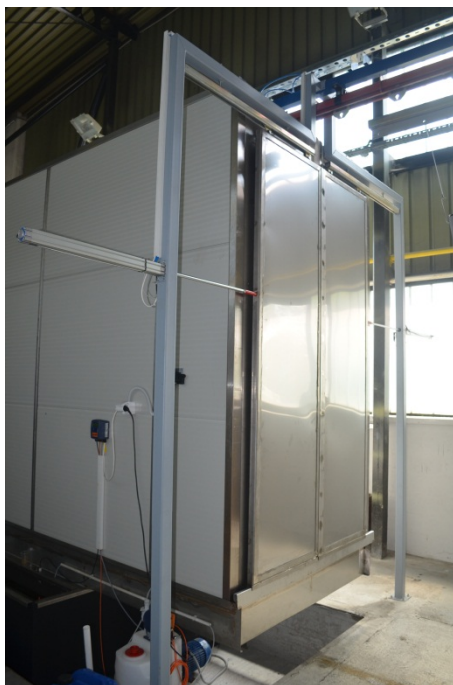
Слика 3.4 Пнеуматски цилиндар коришћен за врата хемијске припреме
