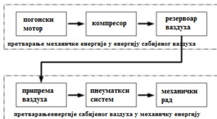
Слика 2.26 Принцип рада пнеуматског система [6]
