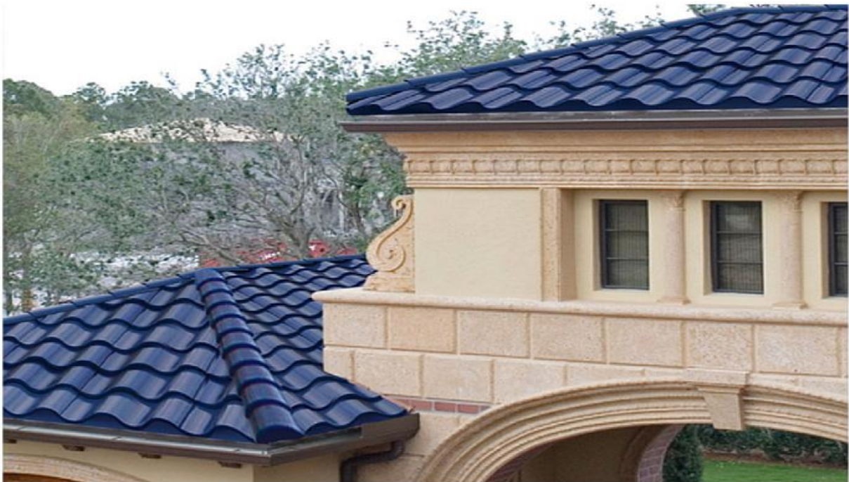
Слика 5.1 Соларне плочице са закривљеном глином [6]
