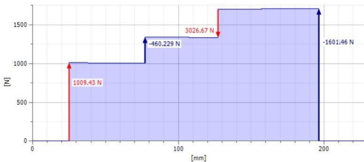
Слика 4.32. Силе у ослоњцима на излазном вратилу
