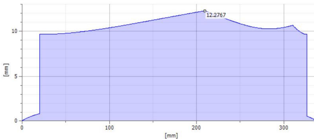
Слика 4.18. Идеални пречник улазног вратила
