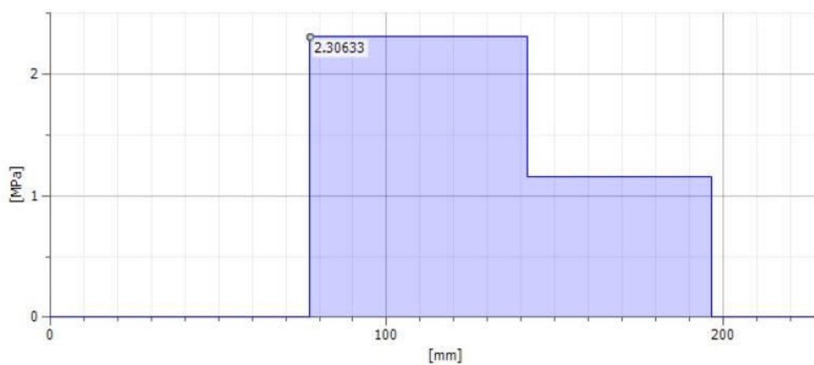
Слика 4.38. Напон на затезање – притисак на излажном вратилу
