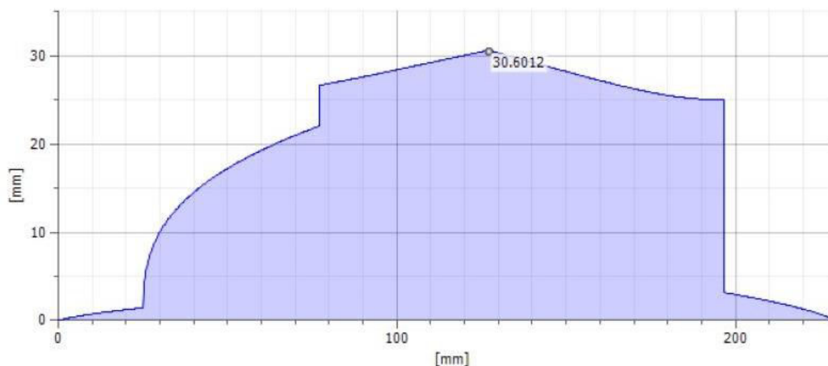
Слика 4.40. Идеални пречник излазног вратила
