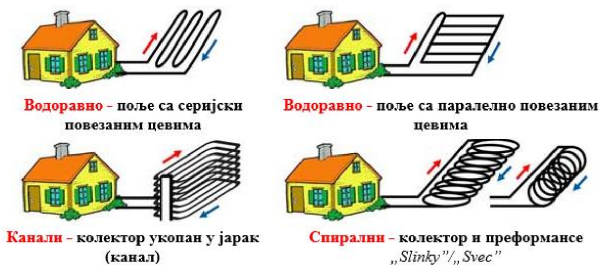
Слика 20. Начини извођења земљаних колекторских поља [21]
