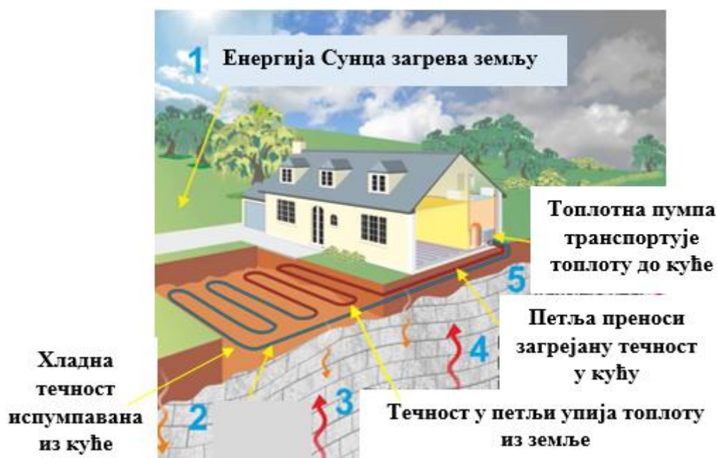
Слика 38. Топлотне пумпе извора земља у Ирској [40]
