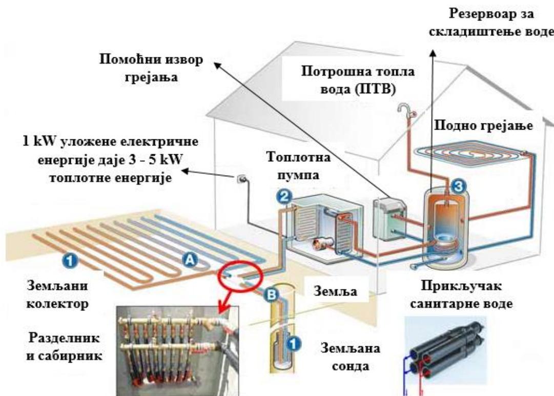
Слика 22. Начин извођења и делови за извођење топлотне пумпе са земљаним колектором [1]
