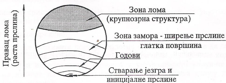
Слика 1.16 - Фазе заморног разарања
