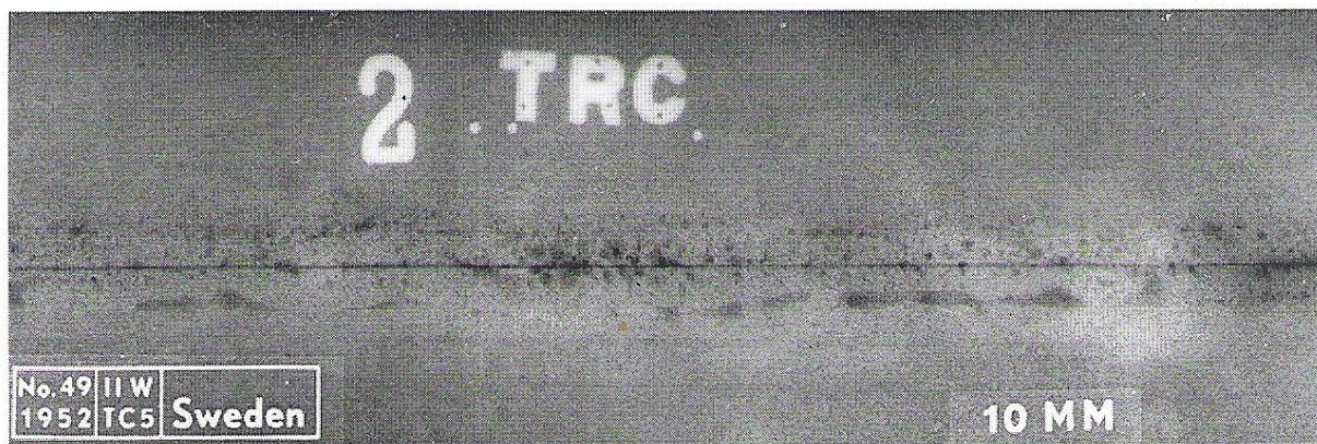
Слика 1.27 – а) Радиограм сучеонеог V шава без грешака б) Радиограм сучеонеог V шава са гасним мехурићима, укључцима троске и непровареним кореном
