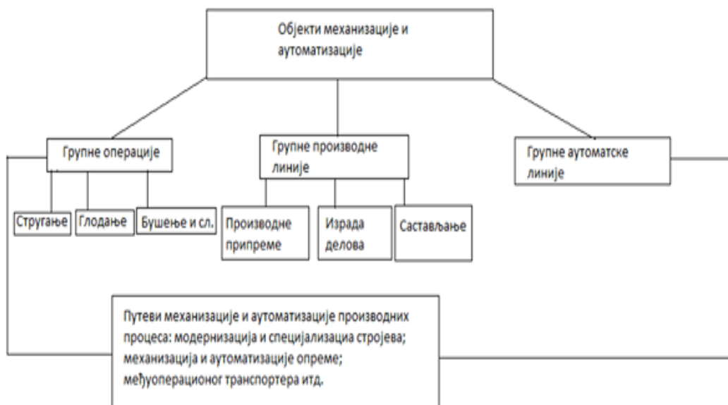
Слика 5.2. Шема механизације и аутоматизације пригрупној обради
