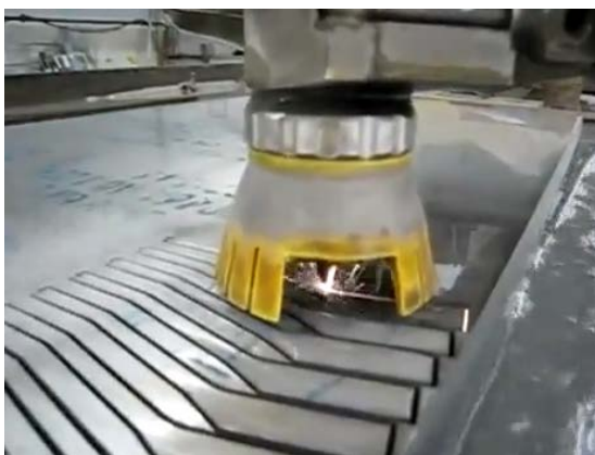
Слика 6.5 Сечење дебљих материјала титана
