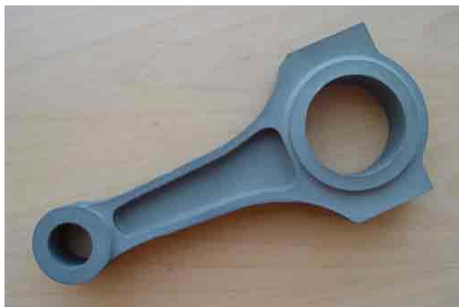
Слика 6.6 Део од титана обликован металургијом праха (синтеровањем)
