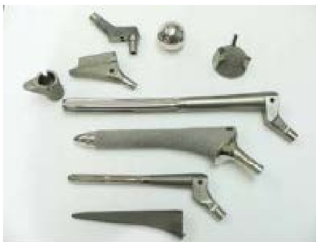
Слика 7.3 Делови направљени од легуре титана који се користе у ортопедији
