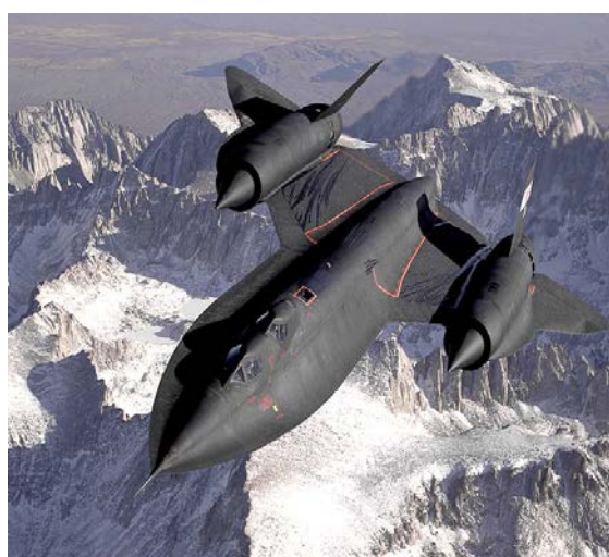
Слика 7.16 Авион Blackbird је био први авион цео направљен од титанових легура
