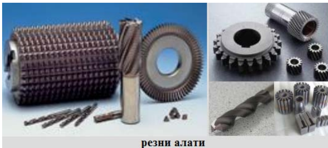
Слика 7.19 Примена титан карбо-нитрид (TiCN) превлака
