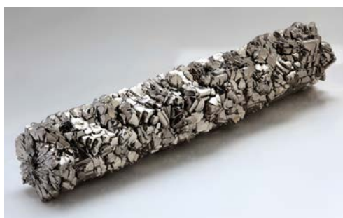
Слика 3.1 Кристал титана добијен van Arkel - de Boer поступком
