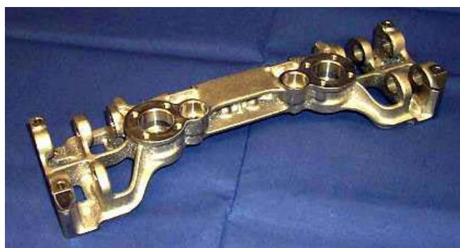
Слика 6.7 Део од титана израђен ливењем
