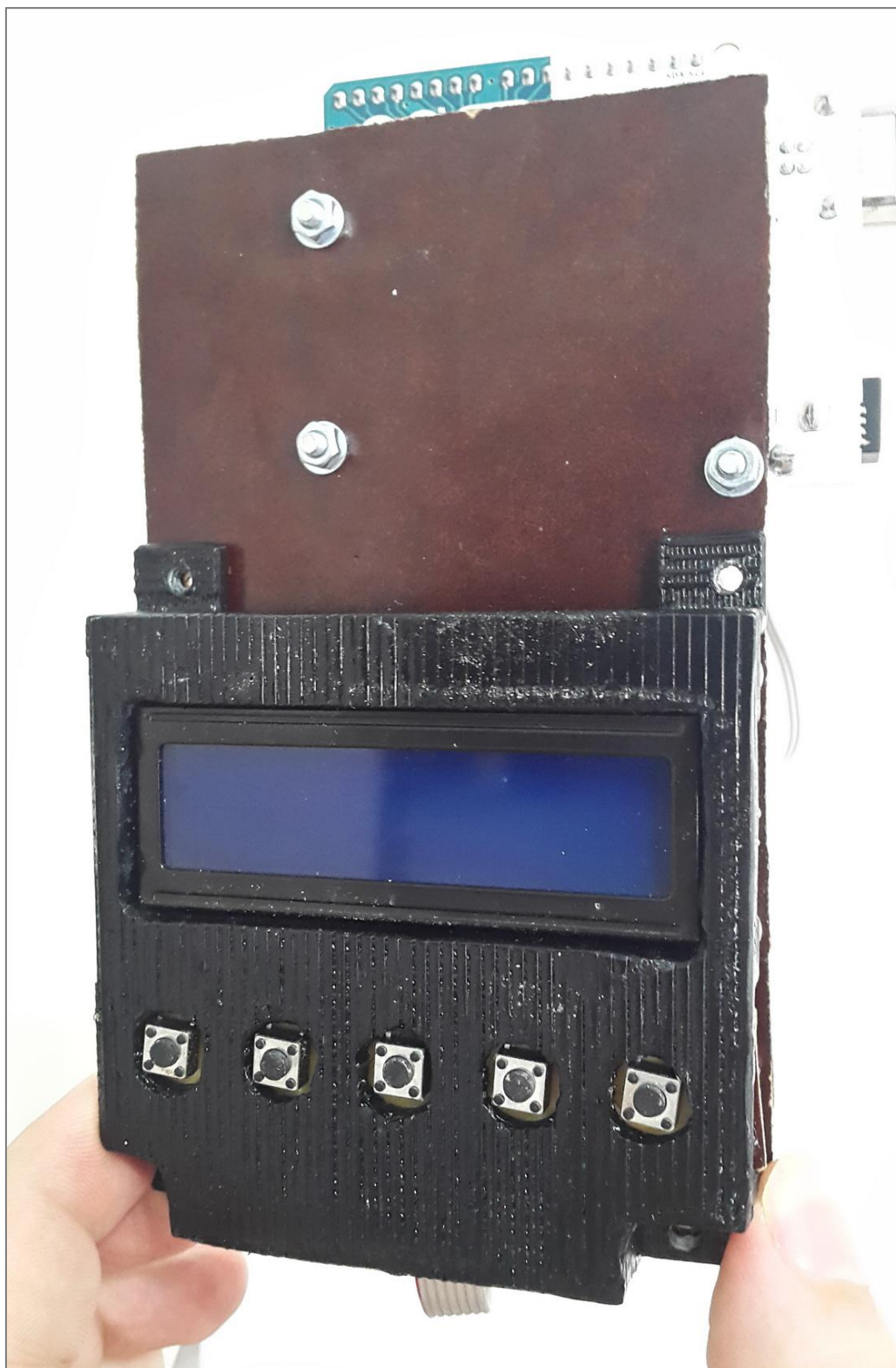
Слика 60. Реализован склоп, поглед са предње стране
