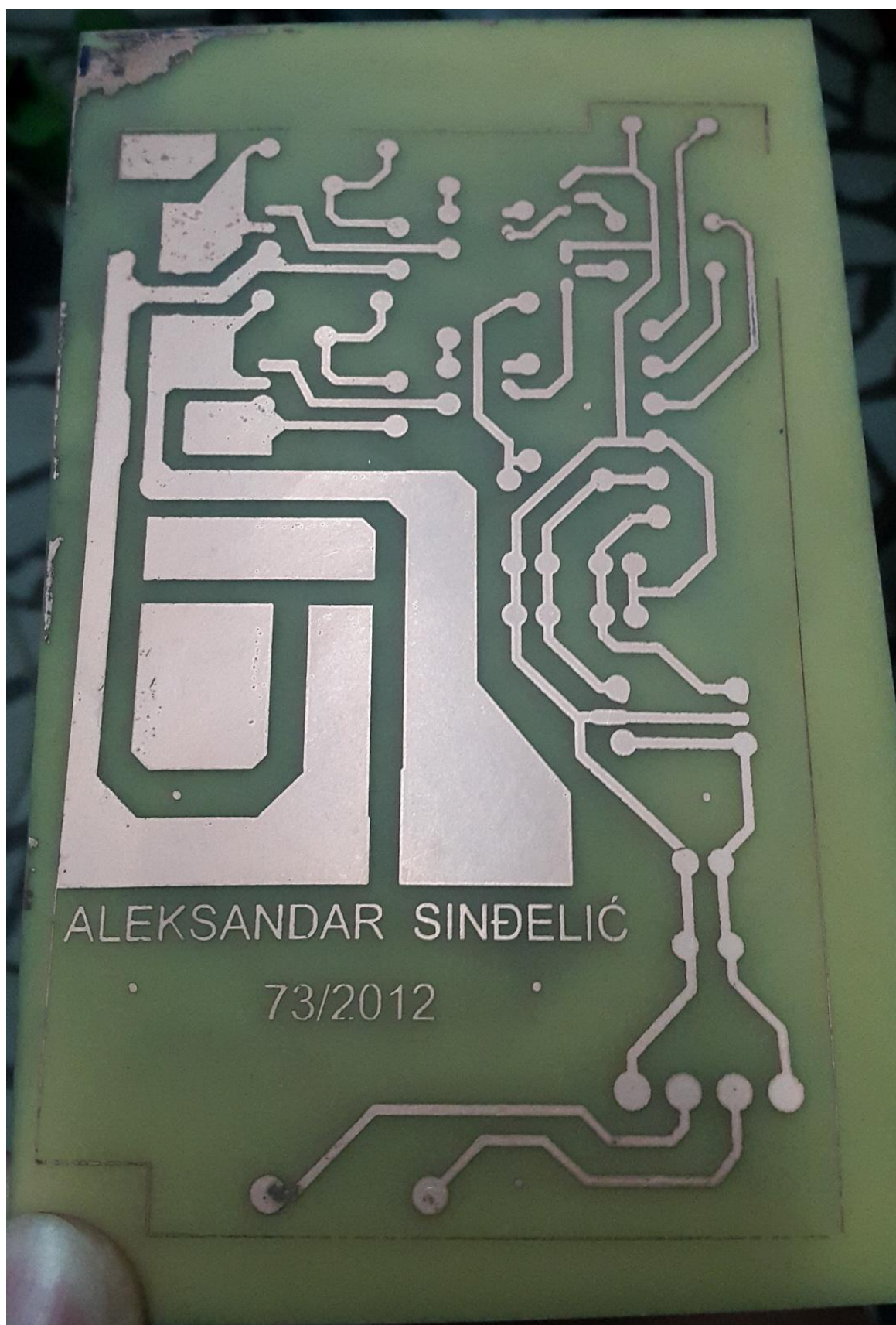
Слика 24. Изглед плочице након отклањања вишка бакра
