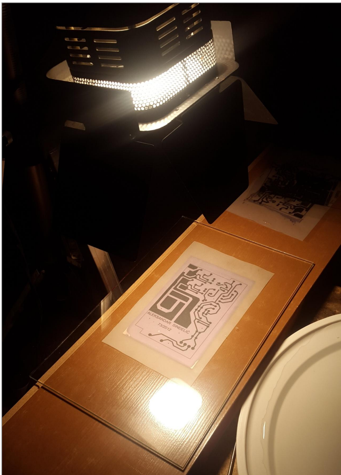
Слика 20. Осветљавање плочице рефлектором
