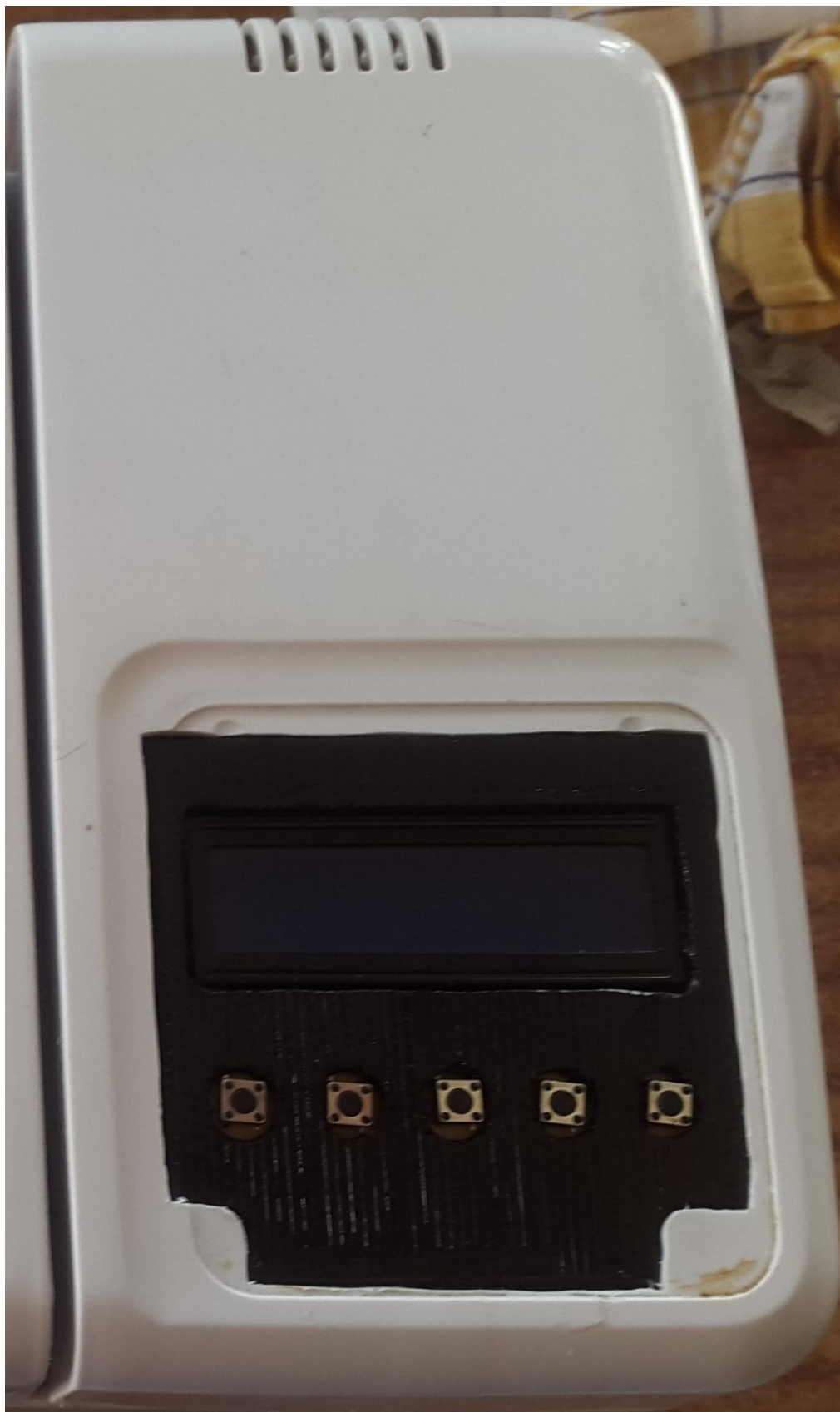
Слика 64. Предњи панел са прикаченим склопом, поглед са предње стране
