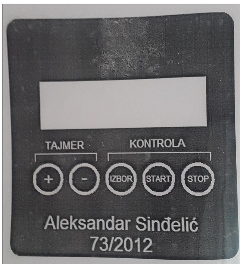
Слика 68. Дизајн налепнице отштампан на провидној термо фолији
