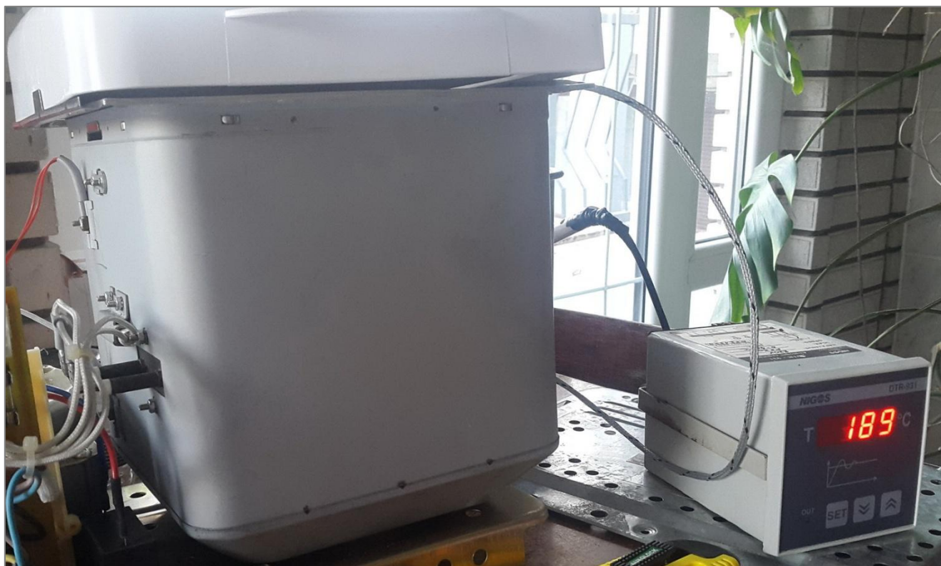
Слика 12. Мерење температуре за време калибрације температурних сензора
