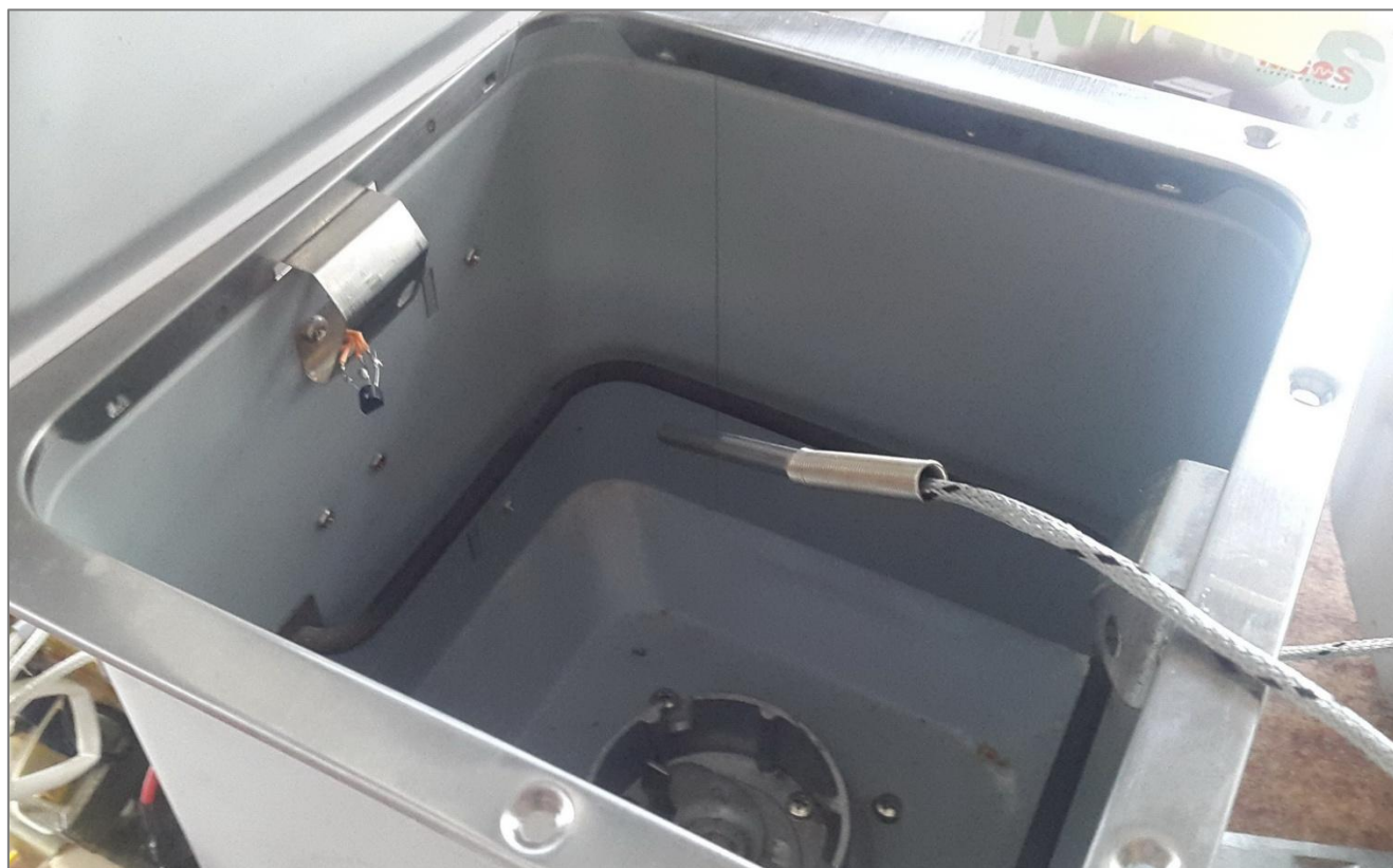
Слика 13. Сonda за мерење температуре на пекарским пећима
