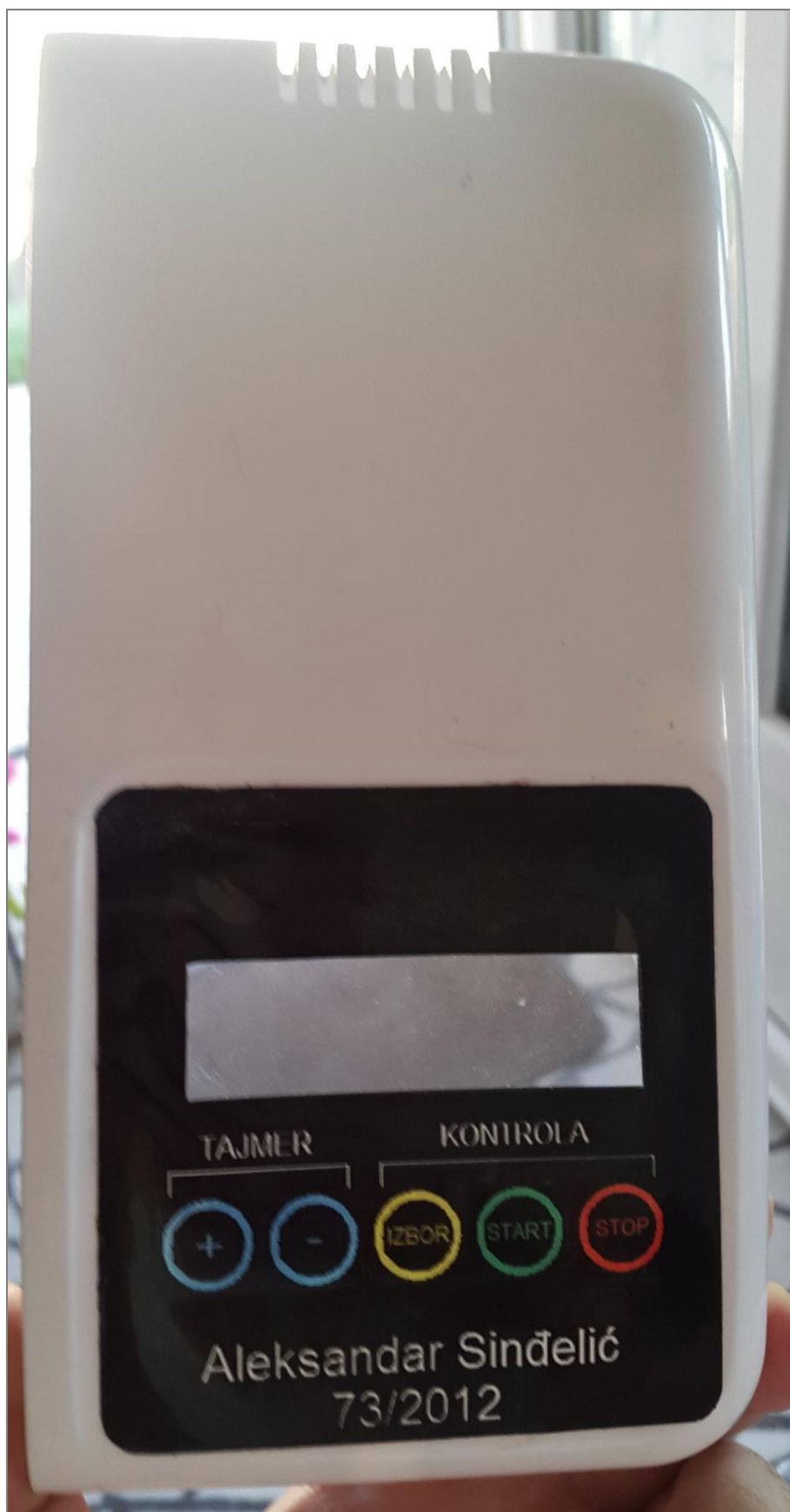
Слика 71. Налепница залепљена на предњи панел, поглед са предње стране
