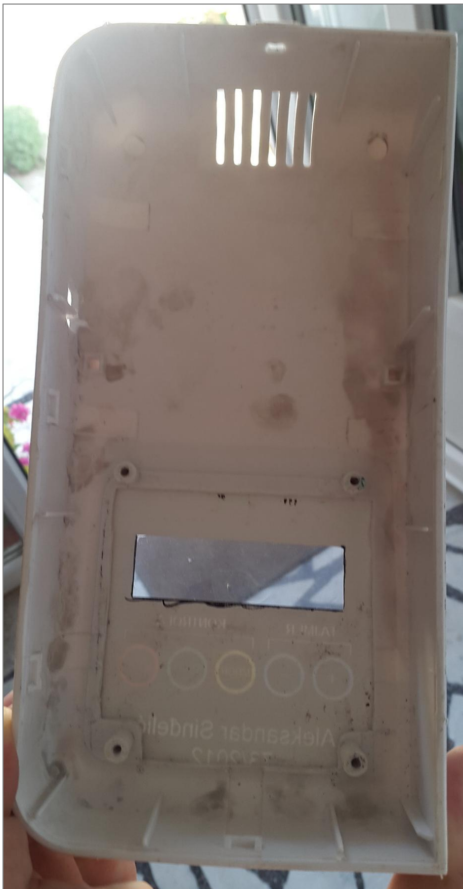
Слика 70. Налепница залепљена на предњи панел, поглед са задње стране
