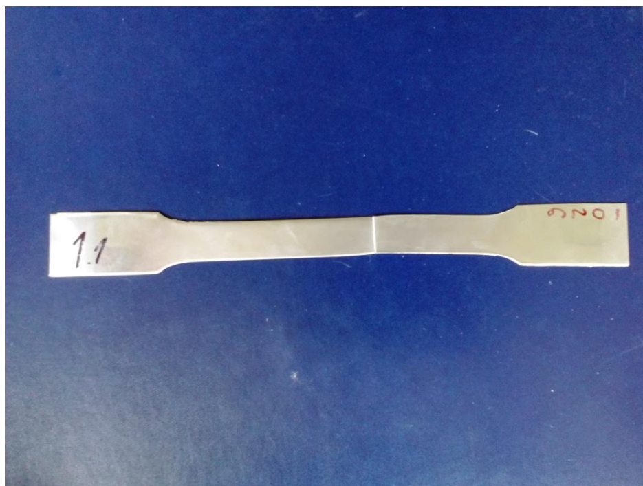
Слика 7.4 Реалан изглед епрувете од X5CrNi18 9(10) после разарања
