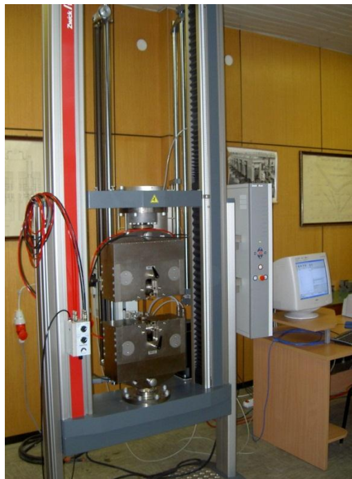
Слика 7.1 Машина за испитивање епрувета на једноосно затезање типа ZWICK/ROELL Z 100
