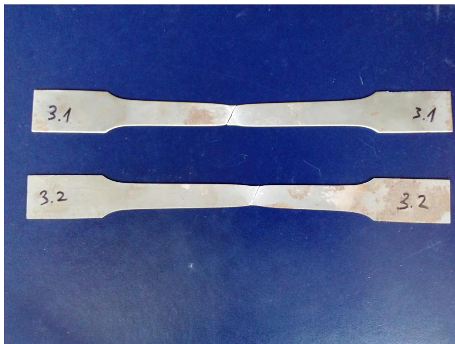
Слика 7.14 Реалан изглед епрувета од челика ознаке Č0148 (DC 04)
