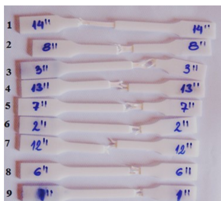
Слика 10.8 Епрувете после кидања, девет испитивања, трећи узорак
