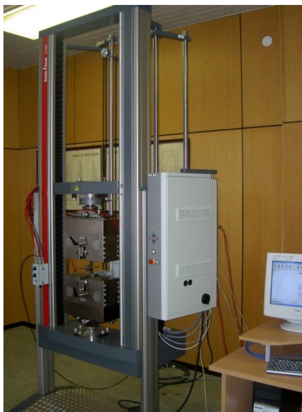
Слика 10.3 Компјутеризовани мерни систем за испитивање материјала ZWICK/ROELL Z 100
