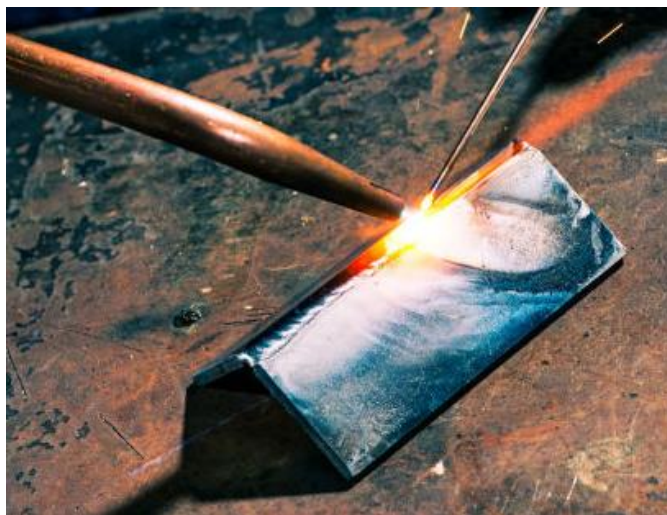
Слика 5.1 Поступак гасног заваривања [19]
