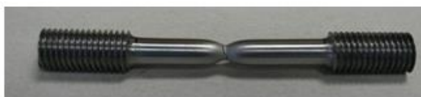
Епрувета после испитивања затезањем - ОМ
