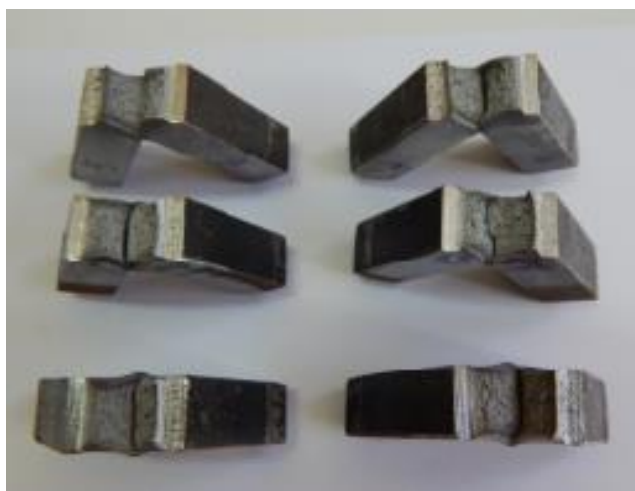
Слика 9.4 Изглед епрувета после лома-заварен спој-ОМ
