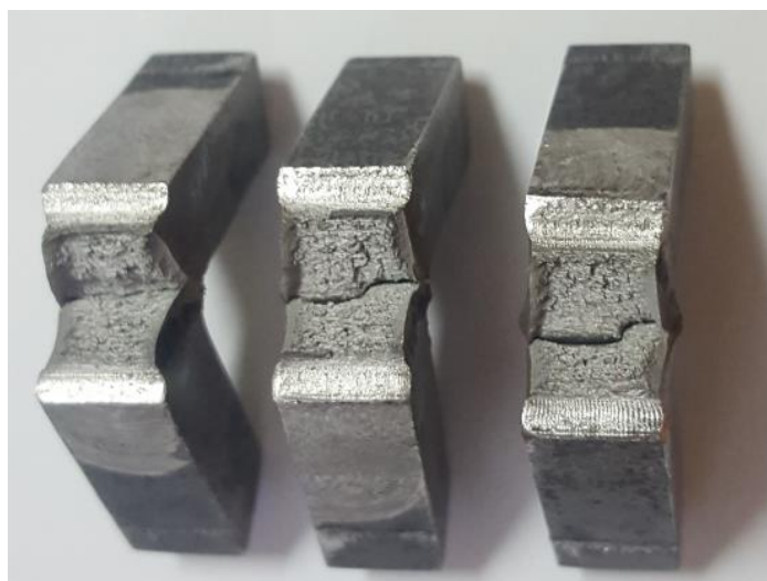
Слика 9.8 Изглед епрувета после лома-заварен спој-ЗС
