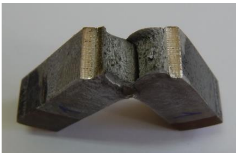
Слика 9.10 Изглед епрувете после лома-заварен спој-ЗУТ
