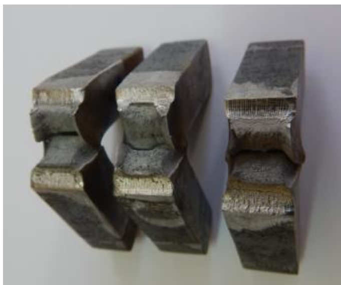
Слика 9.6 Изглед епрувета после лома-заварен спој-МШ
