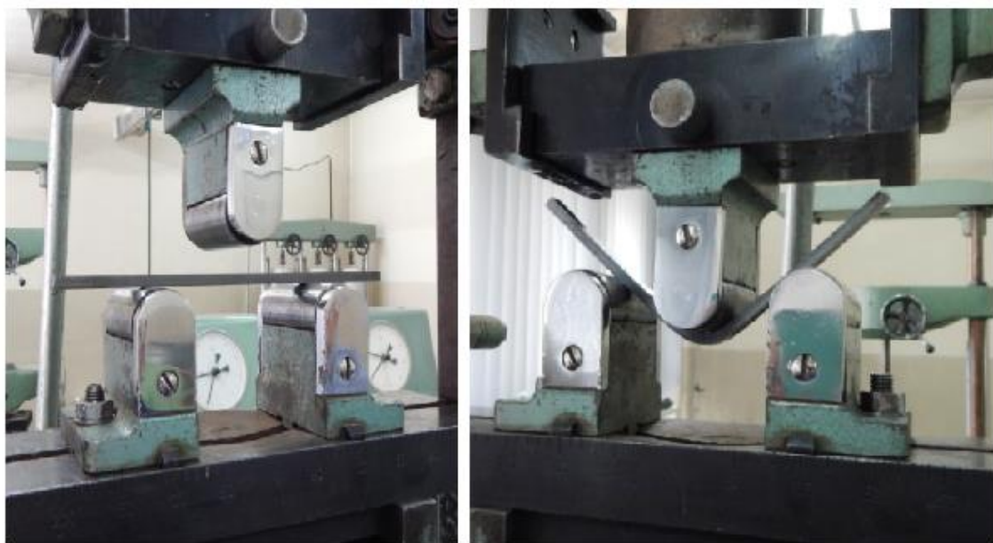
Слика 9.22 Поступак испитивања савијањем
