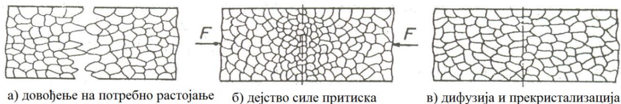
Слика 3.2 Фазе образовања споја притиском [1]
