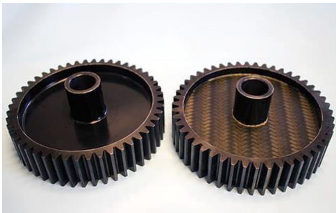
Слика 3.1. Зупчаник од метала (лево) и композита (десно) [15]
