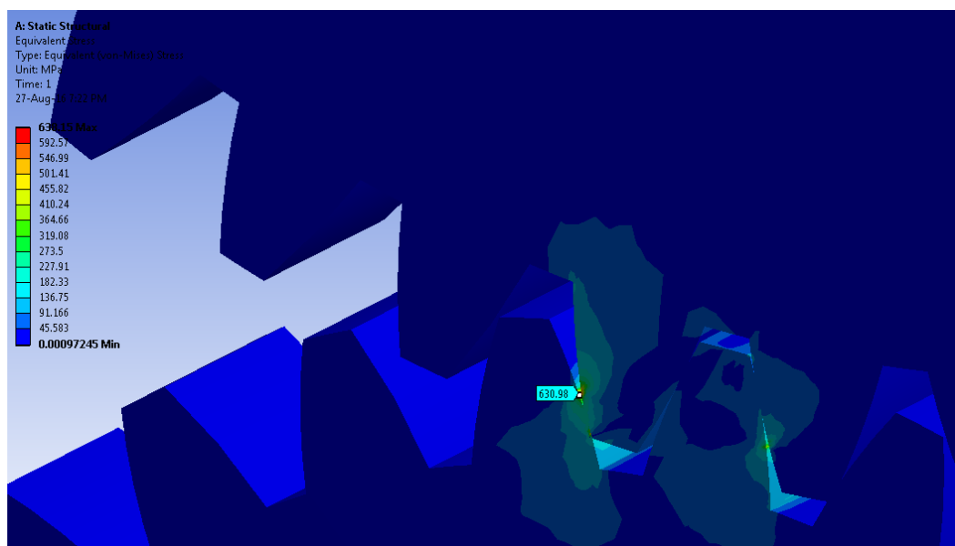
Слика 6.3. Вредност напона на боку зупца зупчаника од PEEK 30GF
