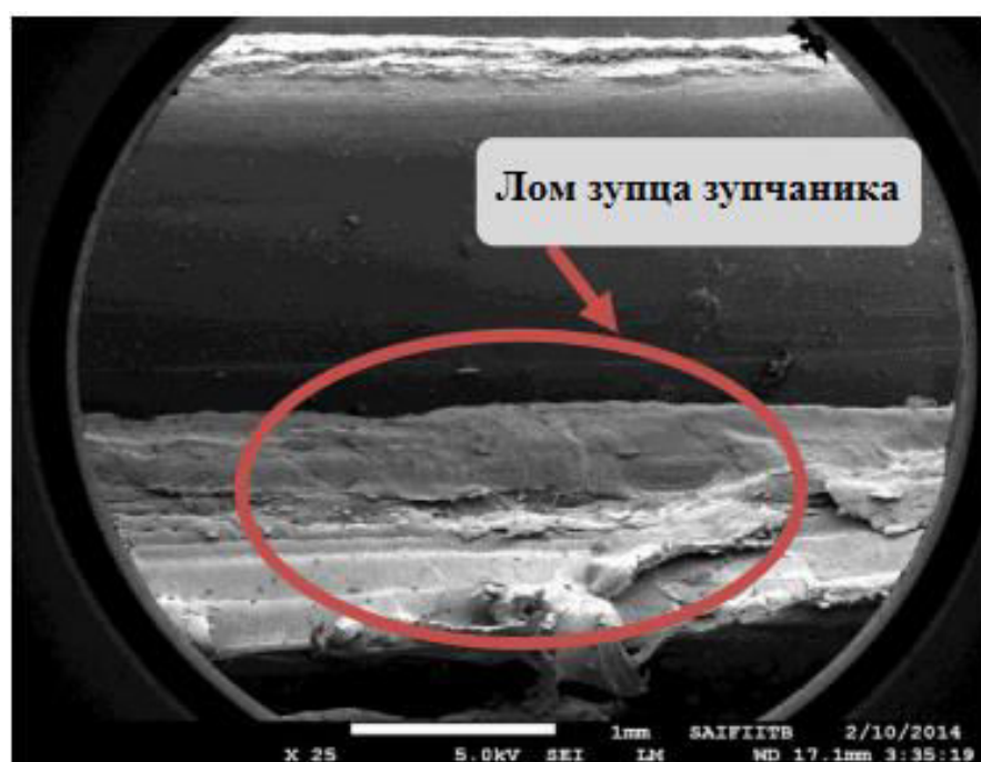
Слика 3.15. Изглед материјала PA66 GF30 након извођења експеримента [11]
