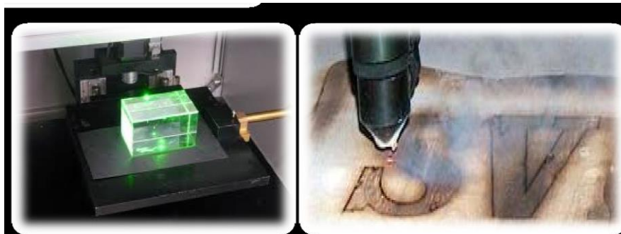
Слика 3.2 Гравирање ласерским снопом
