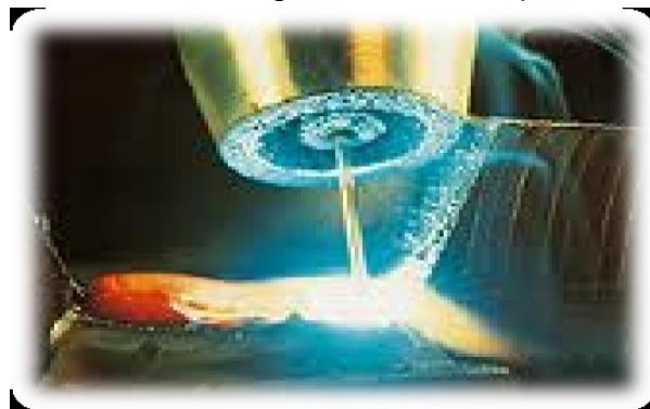
Слика 3.4 Заваривање ласером
