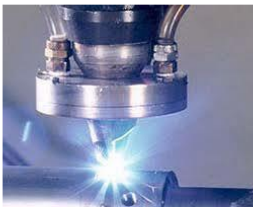
Слика 3.1 Бушење ласером
