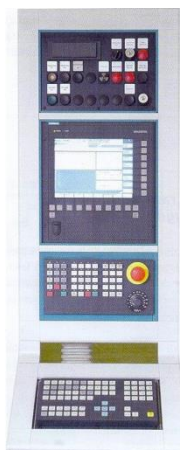
Слика 3.11 Управљачка јединица Siemens Sinumerik 840D CNC је 320-biti са интегрисаним PC-ом
