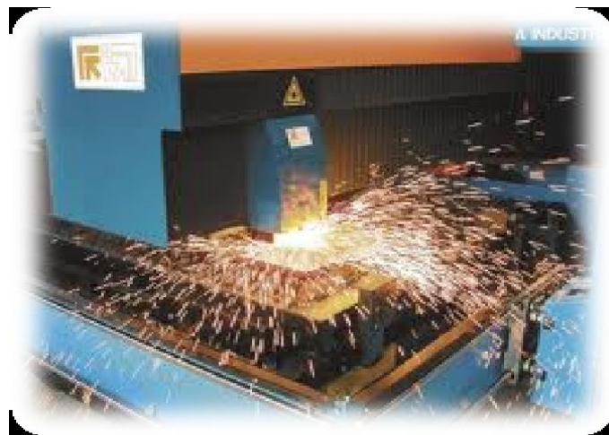
Слика 3.3 Сечење ласером
