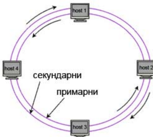
Слика 39. Логичка топологија двоструког прстена у FDDI мрежи [14]
