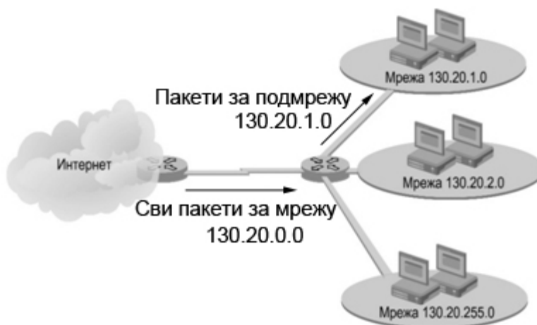
Слика 19. Пример адресирања подмрежа класе B. [31]
