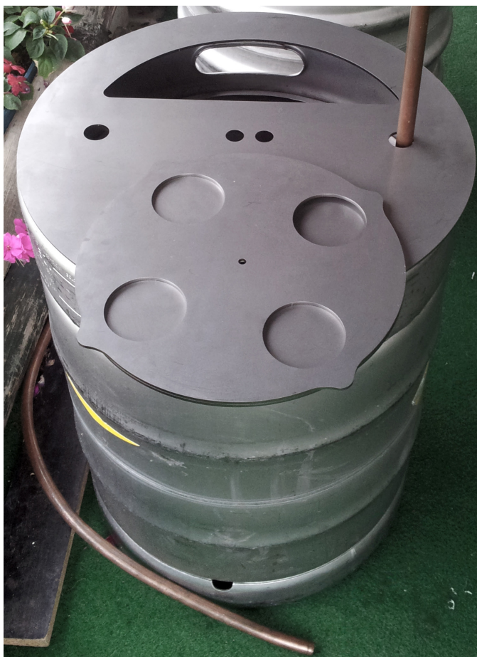
Слика 3.1.1.1.10 - Коначан изглед носеће плоче и плоче механизма додавача хмеља
