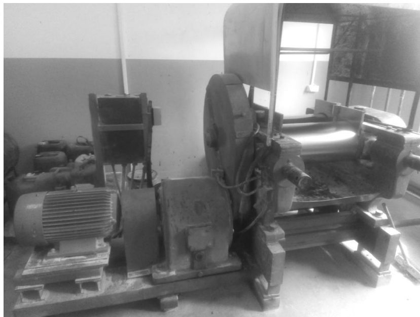
Слика 4.3. Двоваљак за мешање каучукове смеше у предузећу Хемигум Плус
