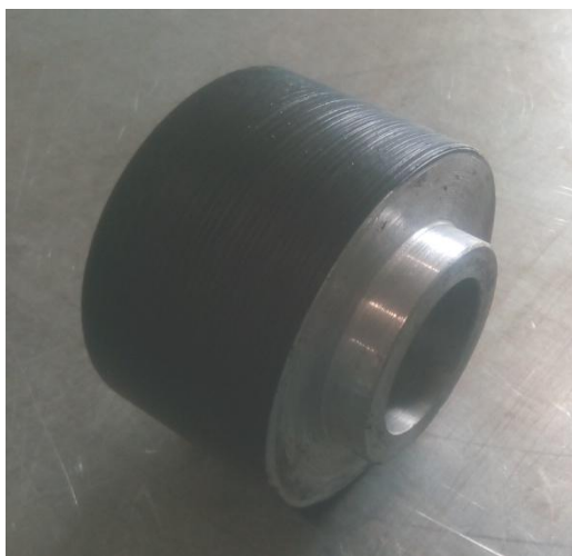
Слика 8.3. Метал премазан лепком у два слоја у предузећу Хемигум Плус
