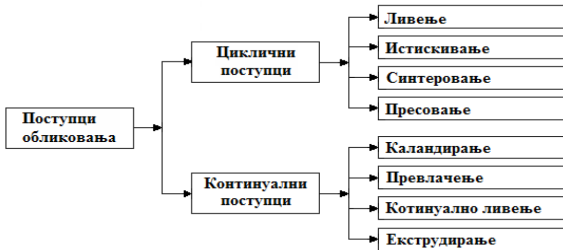
Слика 5.1. Класификација обликовања полимера
