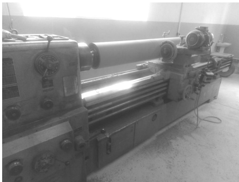
Слика 8.5 Кружно брушење на модификованом универзалном стругу у предузећу Хемигум Плус
