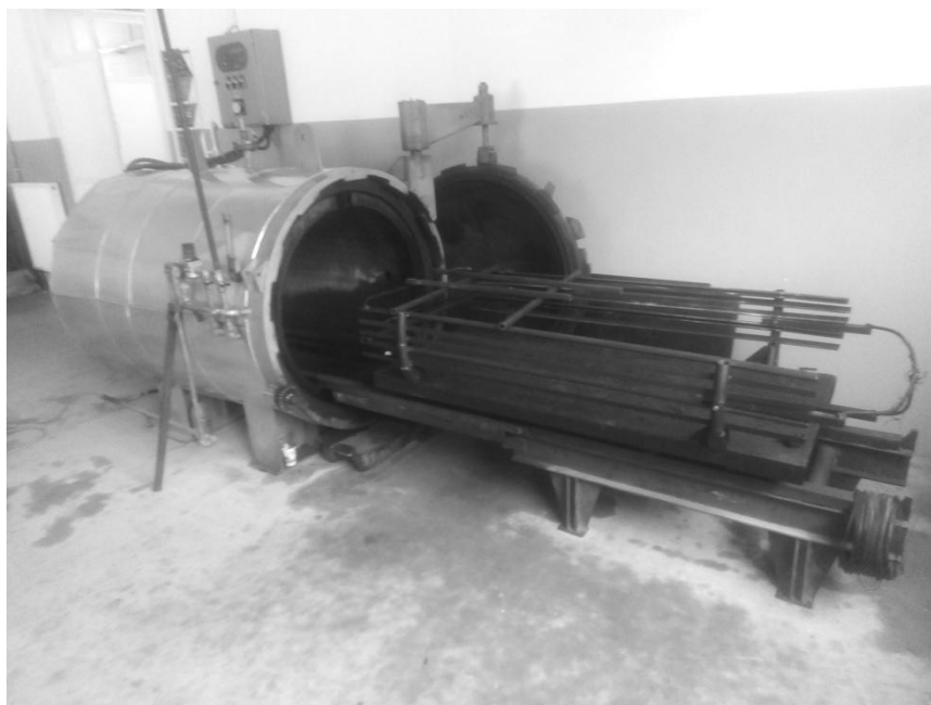
Слика 6.2. Аутоклав за вулканизацију у предузећу Хемигум Плус
