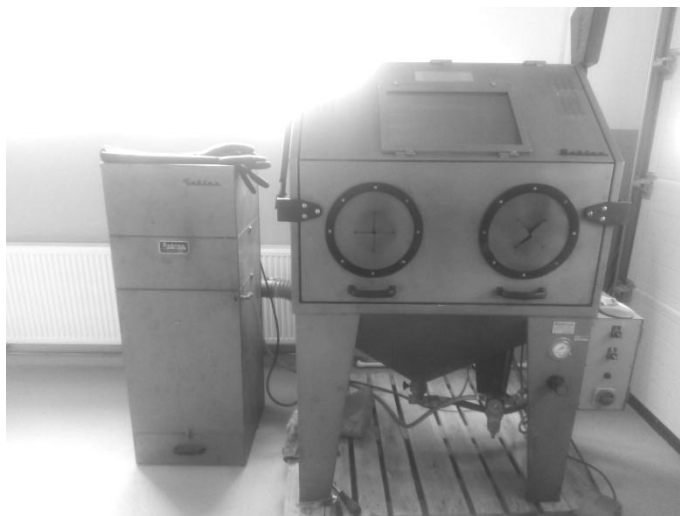
Слика 8.2. Комора за пескарење у предузећу Хемигум Плус
