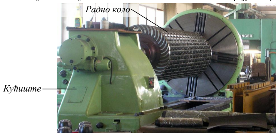
Слика 23 - Радно коло Банки турбине, [29]
