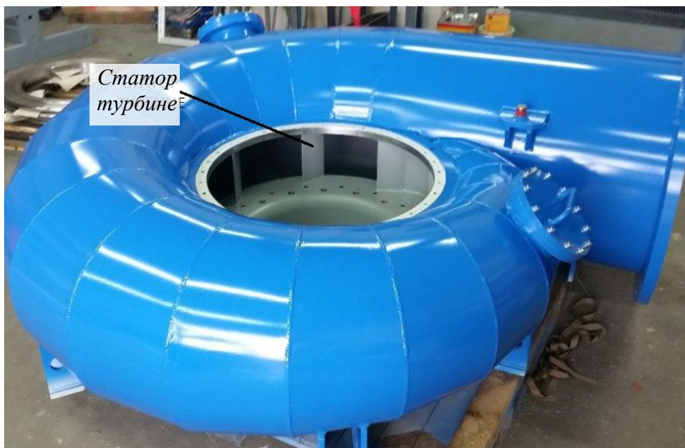
Слика 46 - Спирала Капланове турбине, [50]
