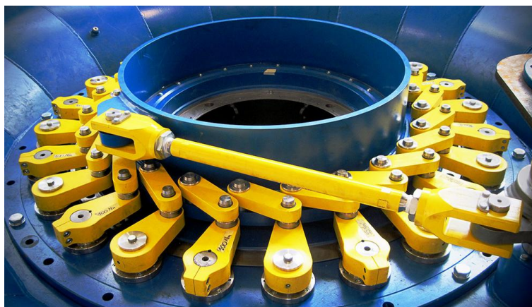
Слика 47 - Механизам за заокретање лопатица спроводног апарата, [49]
