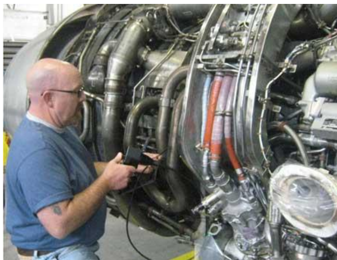
Слика 54. Испитивање мотора авиона коришћењем бороскопа
