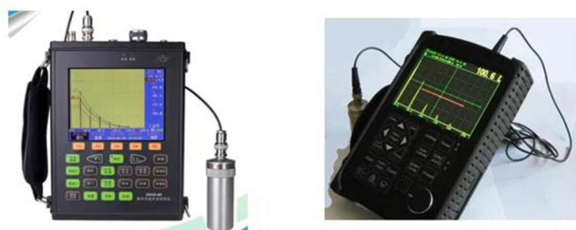
Слика 36. Инструменти за дефектоскопију
