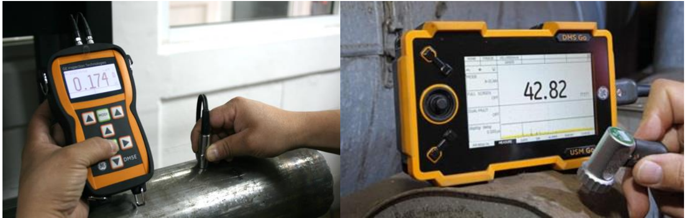
Слика 35. Инструменти за мерење дебљине
