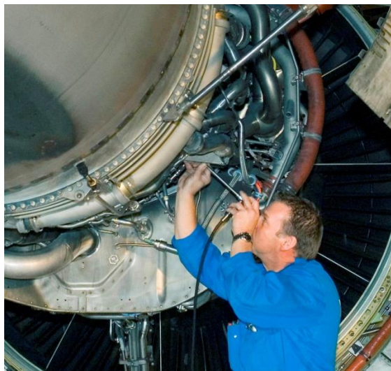
Слика 54. Испитивање мотора авиона коришћењем бороскопа
