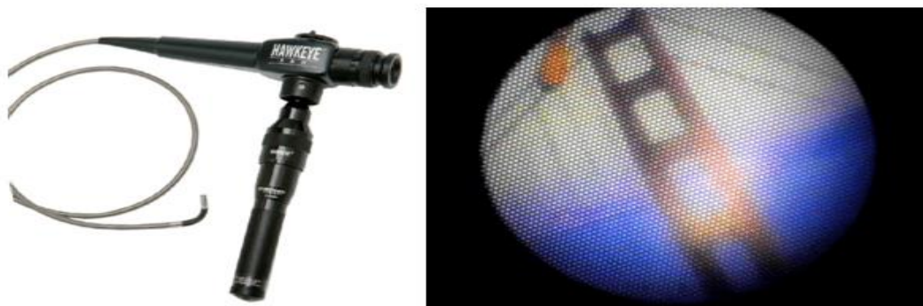
Слика 28. Фибероскоп и пример фиберскопске фотографије
