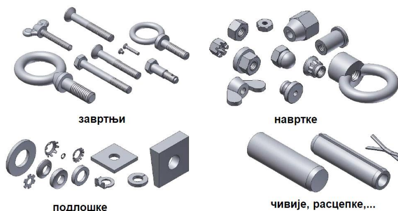
Слика 5.3 Елементи за остваривање навојних спојева [5]
