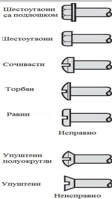
Слика 5.32 Уобичајени типови главе завртњева [9]
