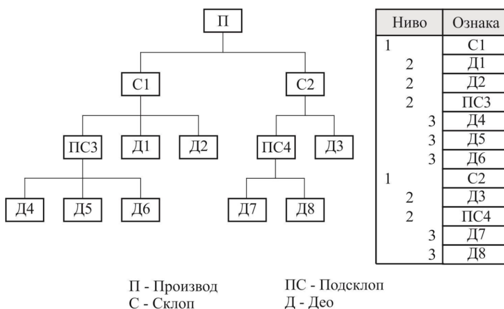
Слика 3.2 Структурна шема (лево) и структурна саставница производа (десно) [10]
