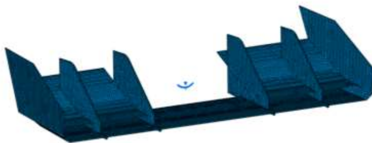
Слика 40. Изглед мреже коначних елемената на предњем спојлеру
