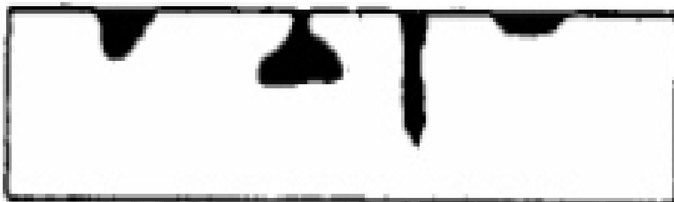
Слика 8. Различити облици кратера настали питингом
