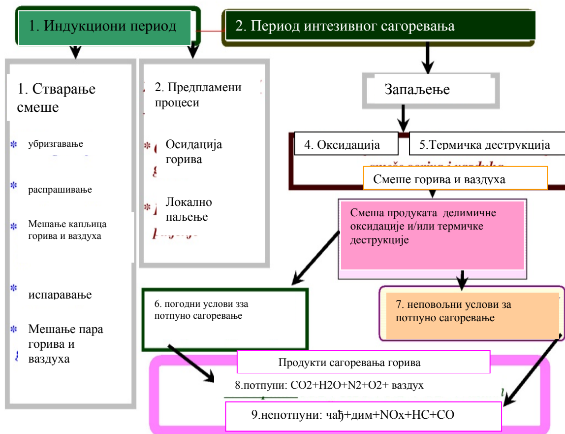
Слика 20: Фазе сагоревања у дизел моторима [1]
