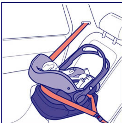
Слика 11. Ауто седиште из групе 0 постављено у смеру супротном од смера вожње 16
