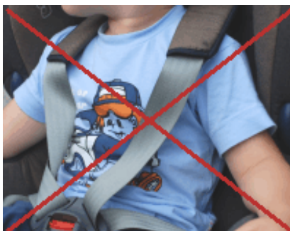
Слика 27. Појасеви ауто седишта нису добро затегнути 15
