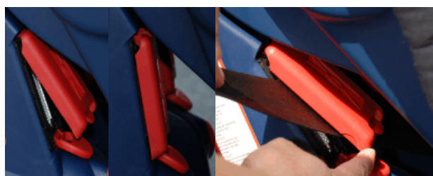
Слика 36. Копча која је фабрички уграђена у ауто седиште 15
