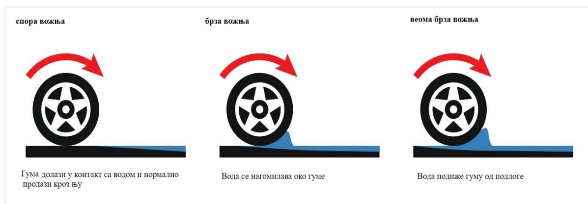
Слика 1.4– Приказ утицаја брзине на аквапланинг [4]
