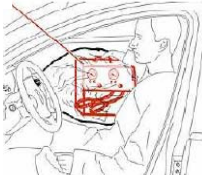
Слика 34. – Принцип вршења провере кчног система
