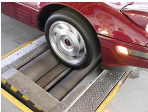
Слика 48.- Провера кчног система код возила
