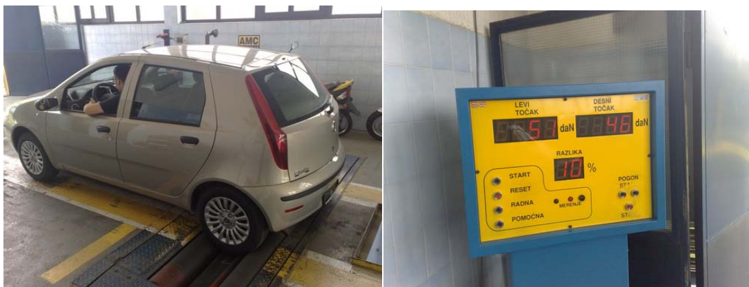
Слика 55. - Приказ возила Fiat Punto за време мерења сила кочења задње осовине на ваљцима
