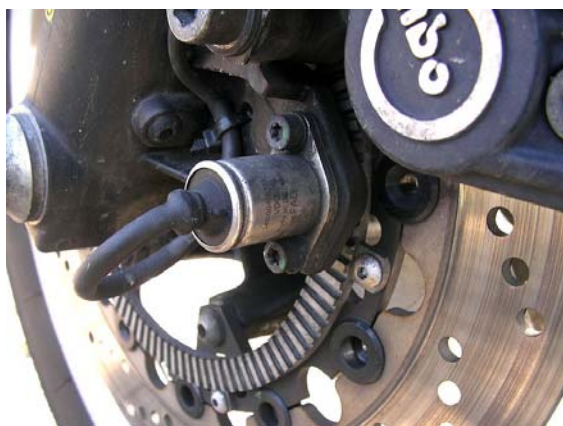
Слика 60. – Индуктивни сензор и назубљени точак
