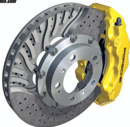
Слика 13. - Ceramic Composite Brake (PCCB), Brembo carbon ceramic
