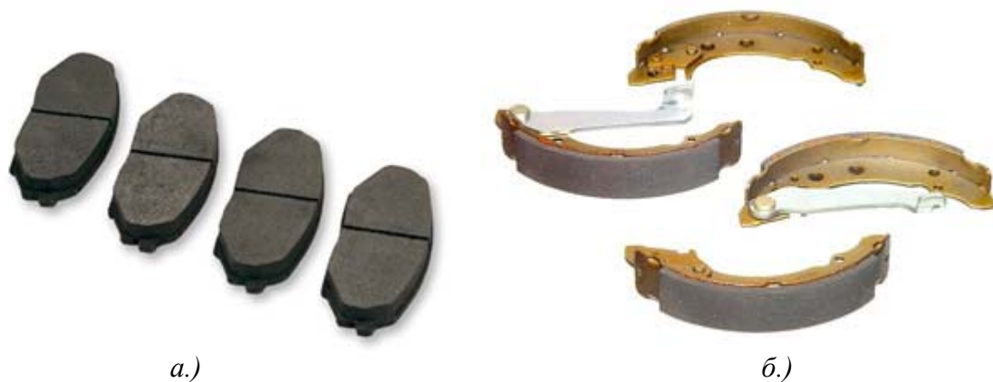
Слика 50. – Кочне плочице а.) за диск, б.) за добош кочнице
