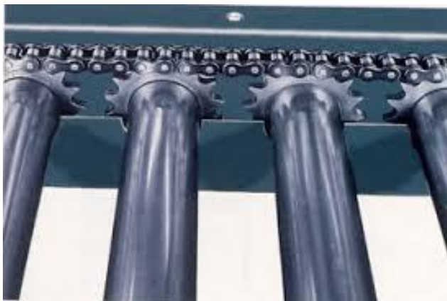
Слика 3.6. Погоњење свих ваљака једним ланцем [9]
