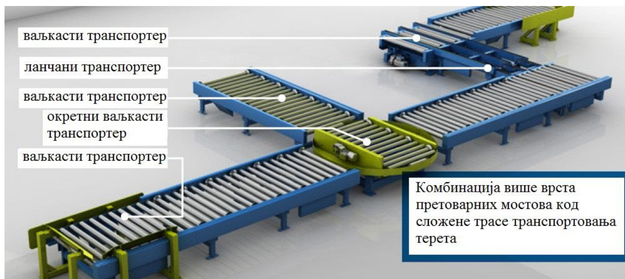
Слика 5.4. Комбинација више врста претоварних мостова код сложене трасе транспортовања терета [7]
