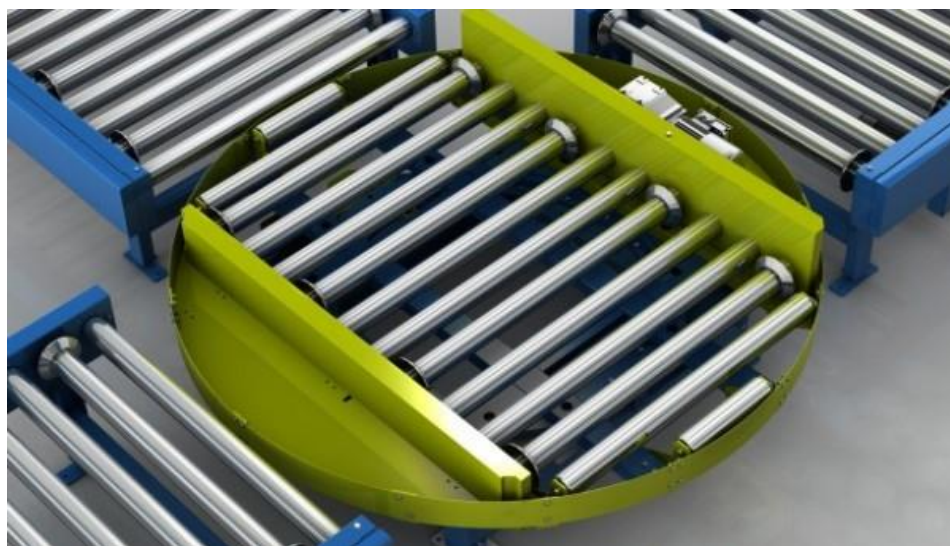
Слика 5.2. Претовар терета помоћу окретног ваљкастог транспортера [5]
