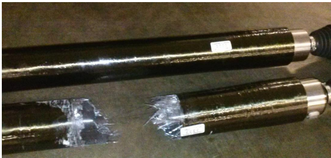
Слика 3.9. Лом једноделног композитног карданског вратила
