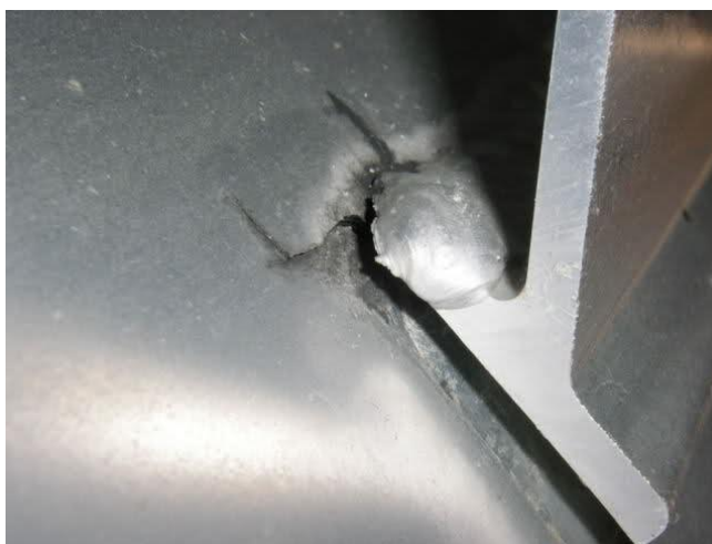
Слика 22 Дефекти израде –Ламинација
