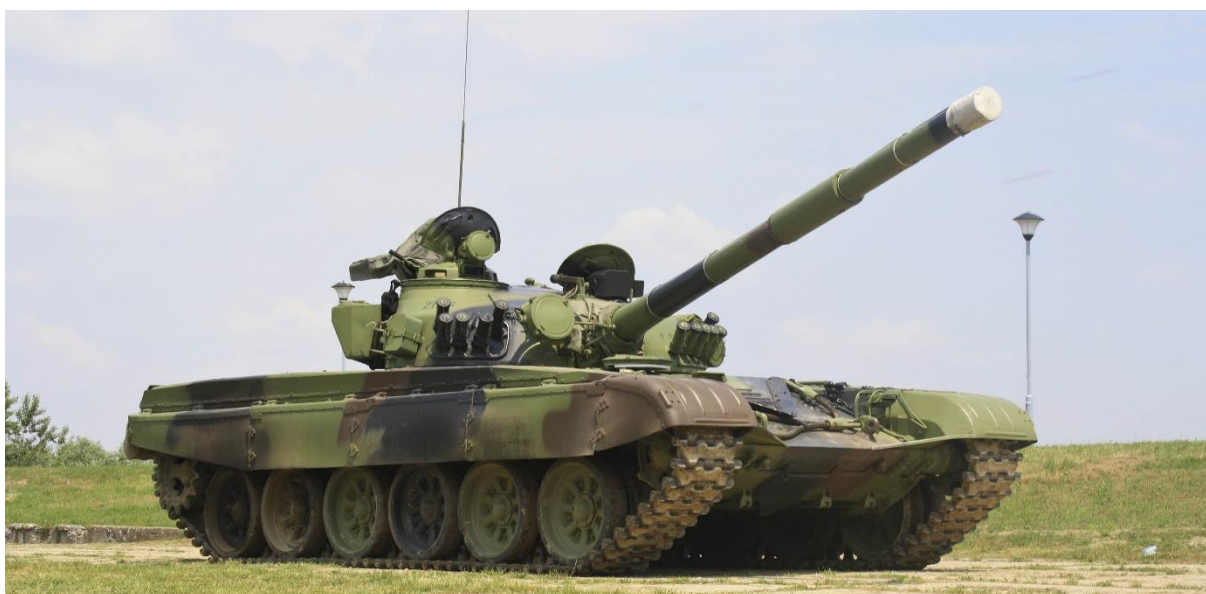
Слика 11: Српски тенк М-84 са одводником барутних гасова на цеви [16]
