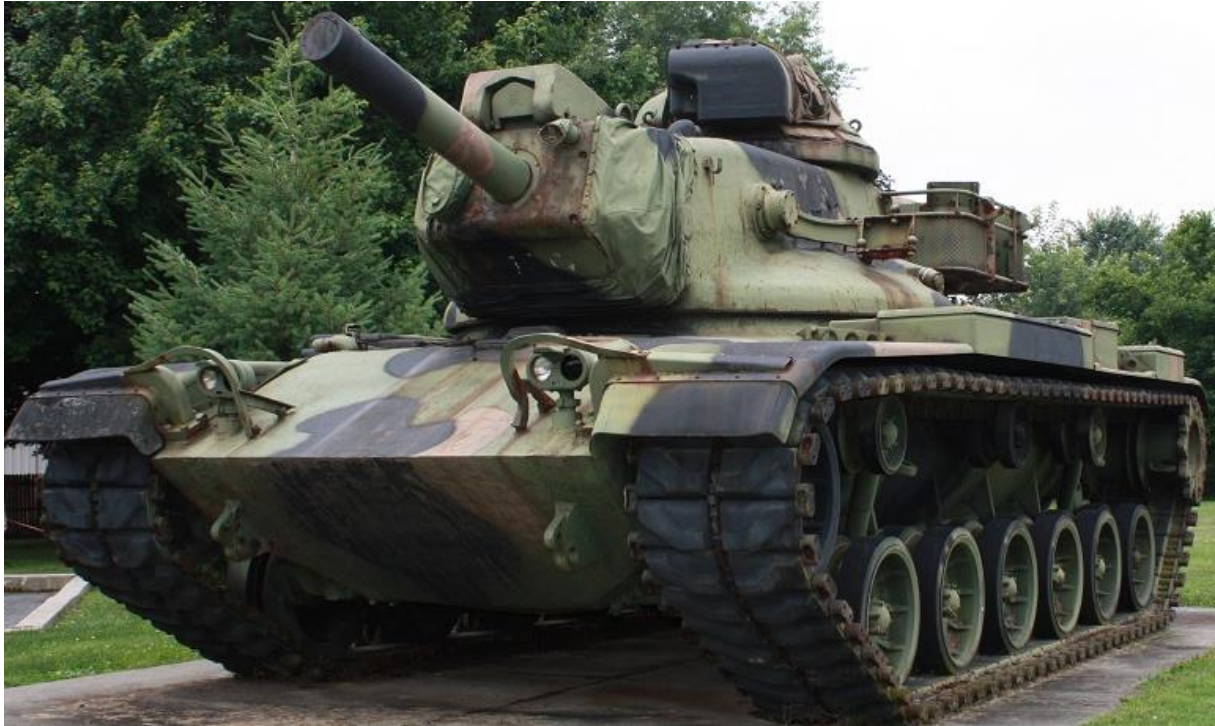
Слика 2: Амерички тенк М60А2, верзија са „СВСС“ (на цеви нема одводника барутних гасова) [9]
