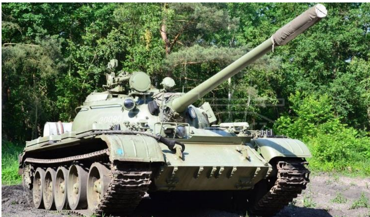
Слика 11: Совјетски тенк Т-55 са одводником барутних гасова на цави [17]
