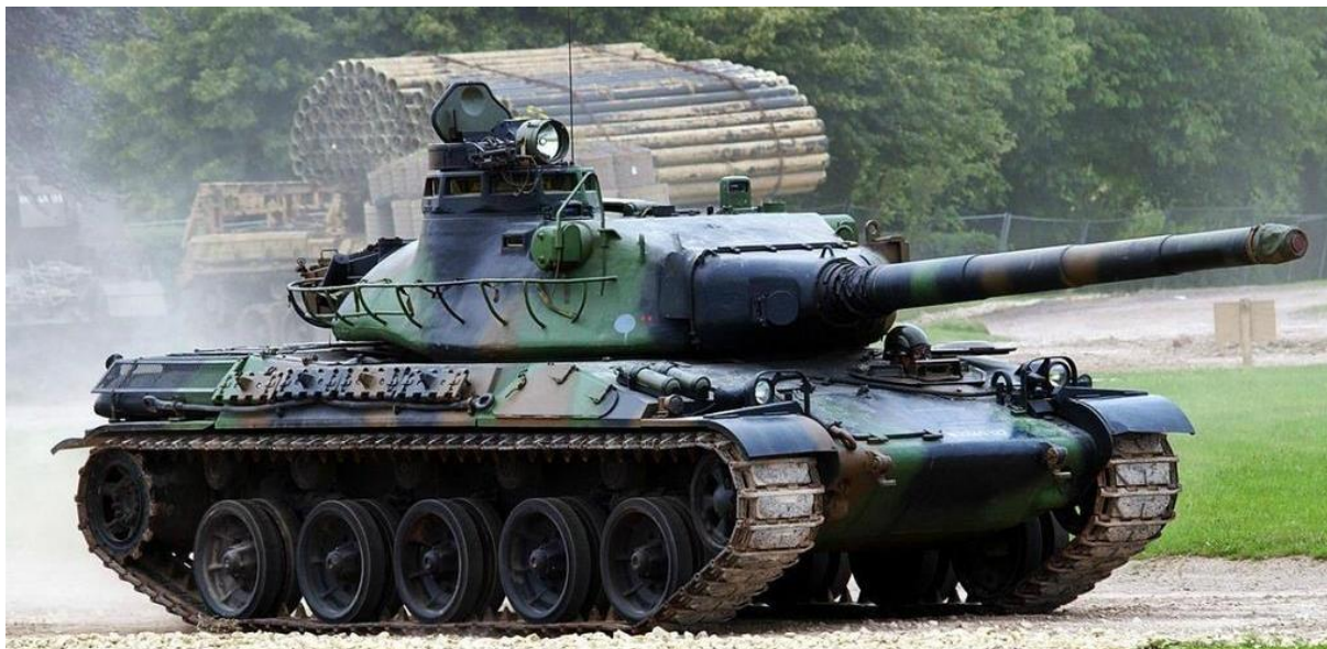
Слика 4: Француски тенк АМХ-30 са топом 105 mm и без одводника [11]
