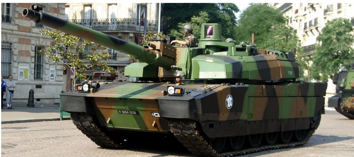
Слика 8: Француски тенк AMX Leclerc без одводника барутних гасова на цеви [15]
