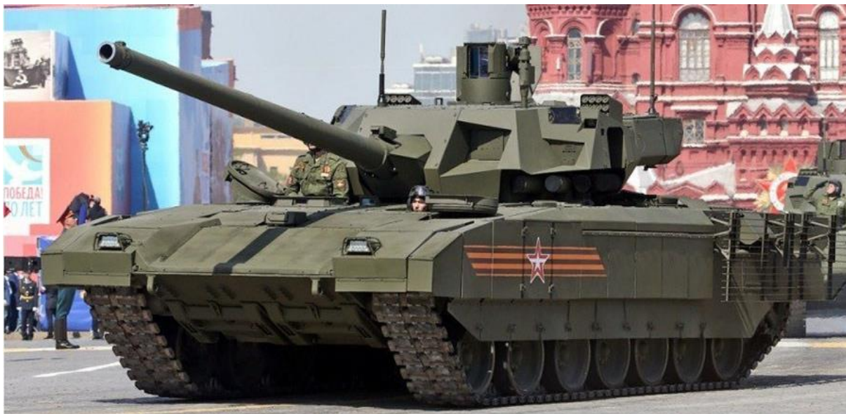
Слика 7: Руски тенк T-14 Armata са беспосадном куполом [14]
