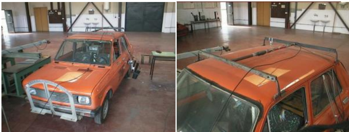
Слика 2.9 Мерна инсталација за мерење торзије каросерије са мерним тракама [9]
