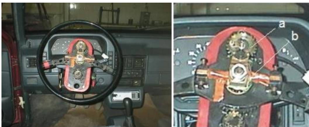
Слика 2.3 Динамометарски точак управљача (лево) и детаљи динамометарског точка управљача (десно): а – зупчаник на вратилу потенциометра за мерење угла заокретања точка управљача и, б – епрувете са мерним тракама за мерење момента заокретања точка управљача [9]
