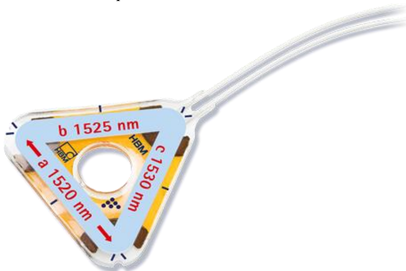
Слика 1.8 Оптичке мерне розета базирана на Браговој оптичкој решетки (K-OR) за одређивање правца и интензитета главних напона [6]
