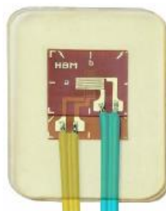
Слика 1.31 Т-розета НВМ ХV91 за мерење двоосног напрезања [3]
