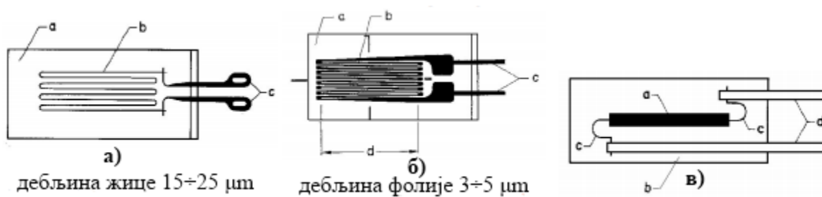
Слика 1.12 Изведбе мерних трака: а) са жицом, б) са фолијом, в) полупроводничка (а – прикључци, б – отпорник, жица или фолија, с – носач) [3]
