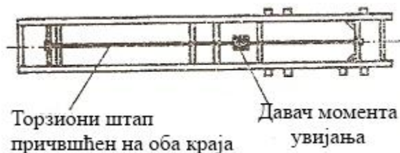
Слика 2.8 Мерна инсталација при мерењу угла увијања шасије теретног моторног возила [1]
