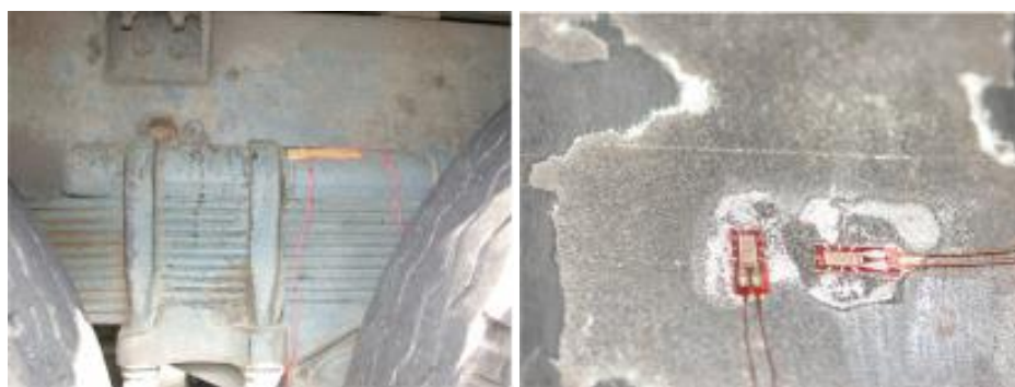
Слика 2.14 Позиције мерних трака на систему ослањања теретног возила [10]
