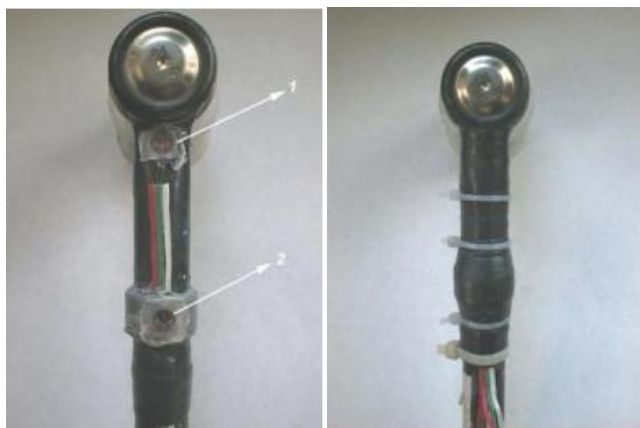
Слика 2.4 Спона возила са мерним тракама: лево - 1 – активна розета, 2 – компензациона розета, десно – заштита розете од спољашњих утицаја [9]
