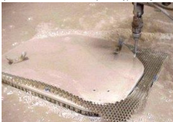
Слика 27. Обрада шупљикавог дела од алуминијума (дебљине 10 mm) [4]
