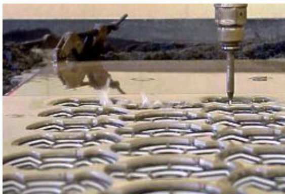
Слика 26. Могућност исецања трослојног материјала (гума – тефлон – тефлон) [4]
