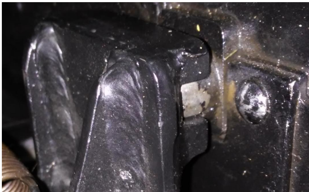
Слика 29. Једна од четири вођица преко којих се остварује контакт митраљеза и колевке
