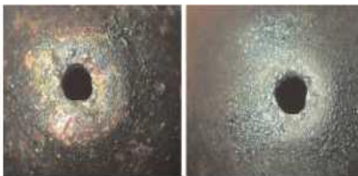
Слика 30. Оштећење спољашњег дела млазнице [12]
