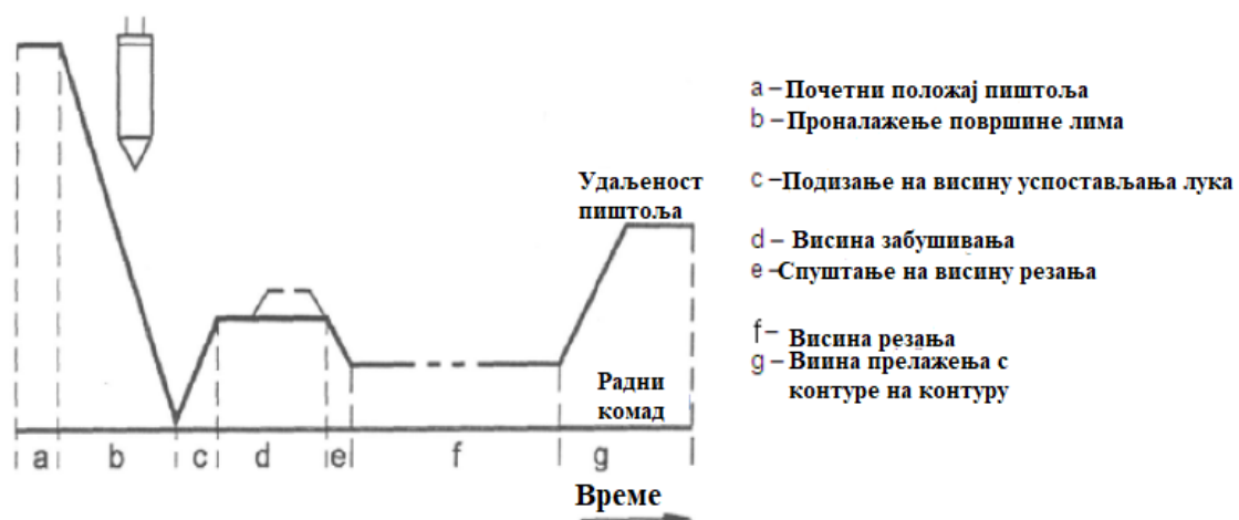
Слика 31. Ток гibaња пиштоља код CNC управљаног резања плазмом [12]
