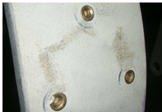
Слика 6.10. а) Геометрија закивка добијена анализом хладног деформисања, б) закивак деформисан у реалним условима производње
