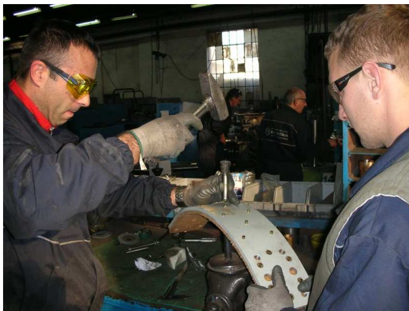
Слика 5.2. Приказ процеса закивања тракасте кочнице и облоге у фирми РАПП ЗАСТАВА
