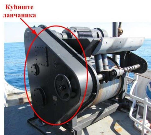
Слика 1.10. а) Приказ витла са кућиштем ланчаног преносника, б) ланчани преносник у пресеку кућишта истог приказан шематски
