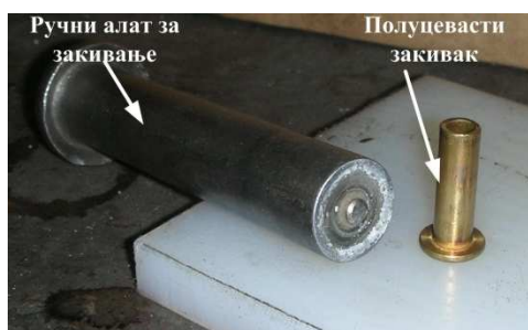
Слика 3.23. а) Алат за закивање тј. спајање траке и облоге кочнице, б) Приказ након закивања траке и облоге тракасте кочнице
