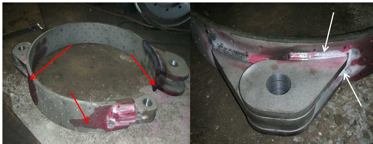
Слика 3.12. а) Тракаста кочница подрвгнута методи пенетранта, б) приказ развијача ношеног после процеса наношења пенетранта
