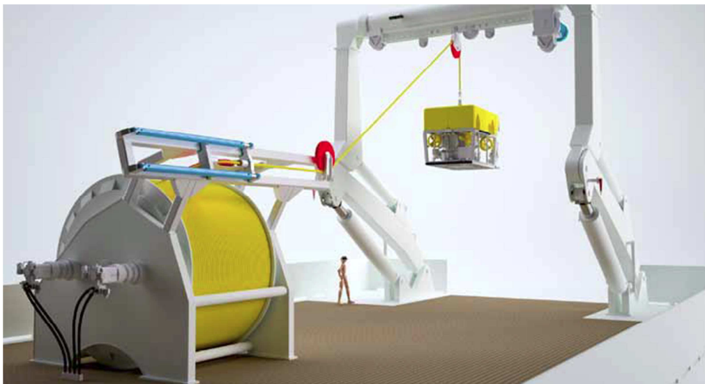
Слика 1.16. Приказ дизања терета на одрђену висину уз помоћ витла односно тзв. „подизање палубе“
