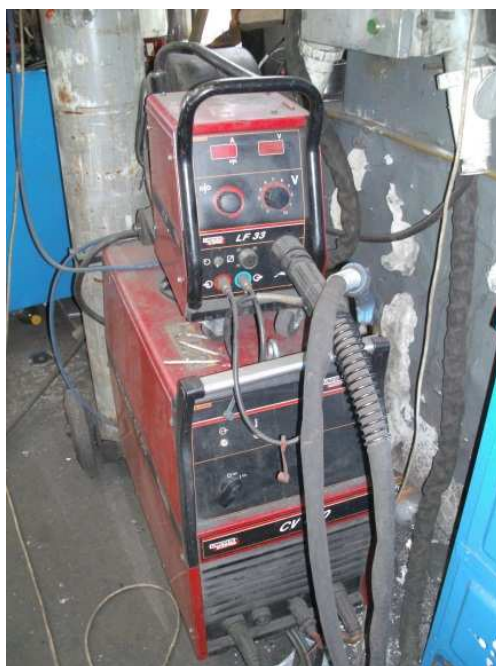
Слика 3.11. LINCOLN Idealarc CV 420 апарат за процес МАГ 135 заваривања
