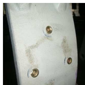
Слика 3.23. а) Алат за закивање тј. спајање траке и облоге кочнице, б) Приказ након закивања траке и облоге тракасте кочнице
