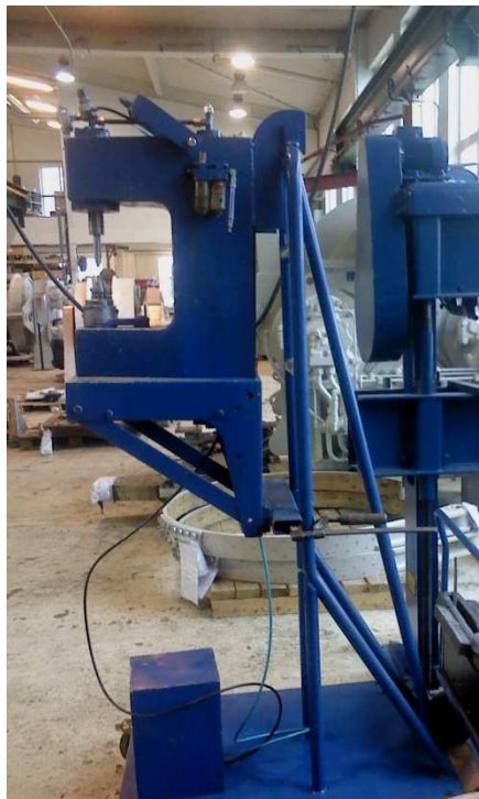
Слика 6.17. Приказ израђене машине за закивање полуцевастих закивака у РАПП ХИДЕМИ у Норвешкој
