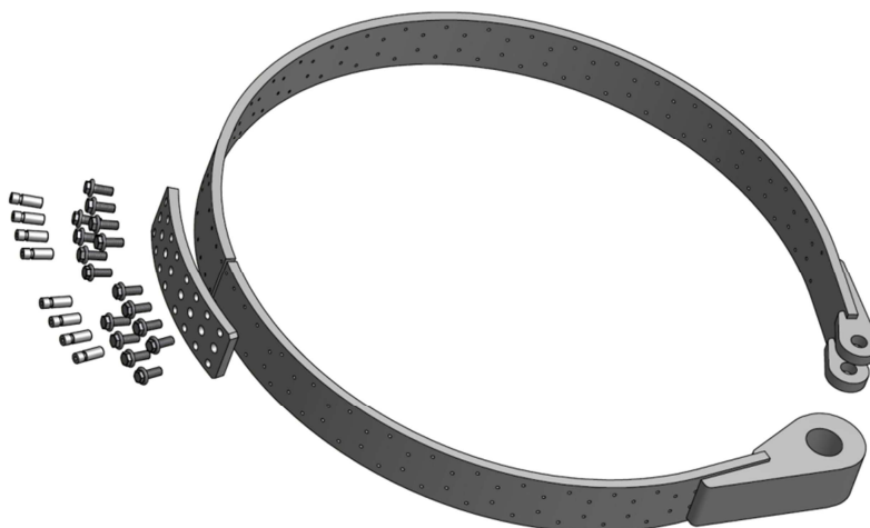
Слика 3.14. Спојница траке приказана у изометрији са везивним елементима
