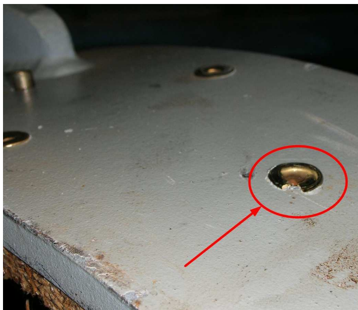
Слика 7.1. Приказ оштећеног закивка - шкарта
