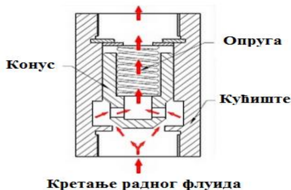
Слика 5.20 Шематски приказ неповратног вентила
