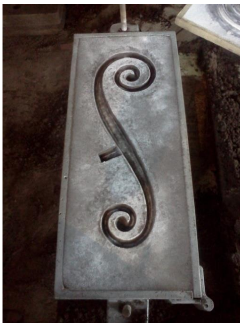
Слика 2.1 Калуп за ливење једног од различитих облика од алуминијума [5]
