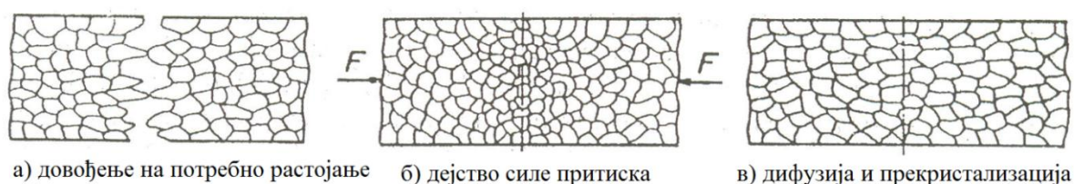
Слика 1.4 Фазе образовања споја притиском [2]
