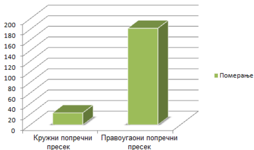
Дијаграм 7.6 – Вредности померања (mm) опруга различитог попречног пресека
