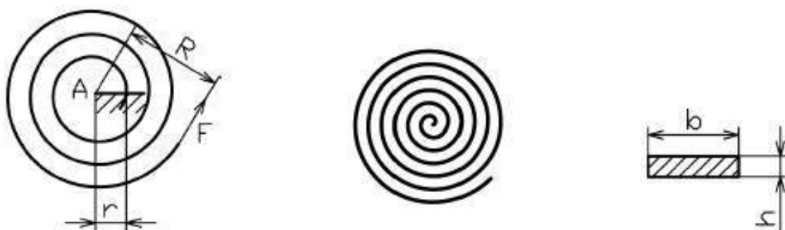
Слика 3.8 – Приказ спиралне опруге
